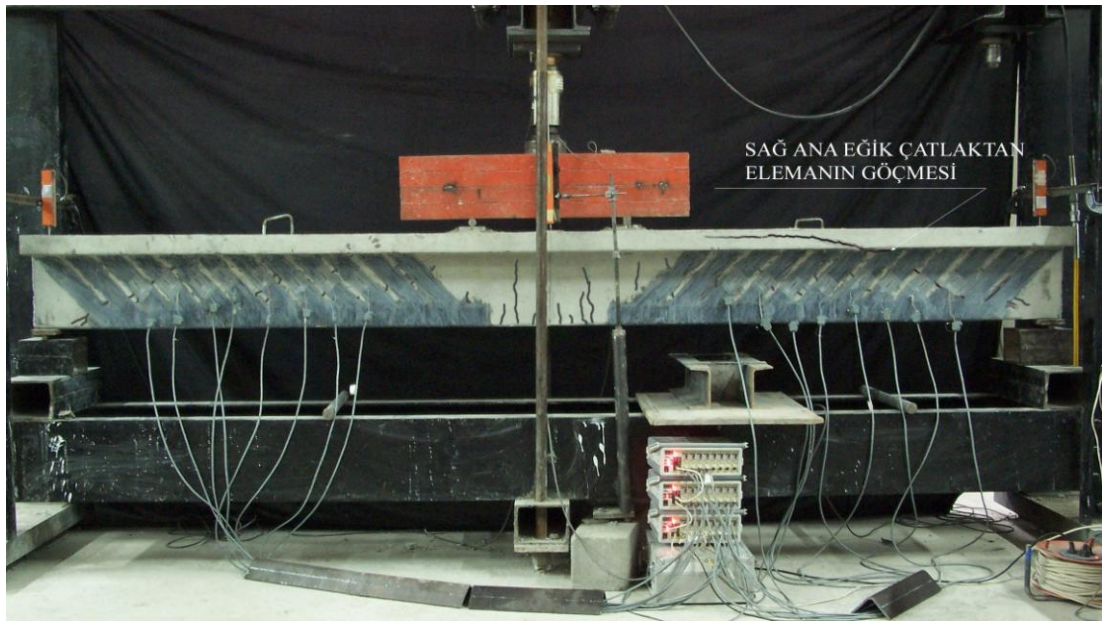
Resim 4.5. Göçmeden sonra, deney elemanı 2
