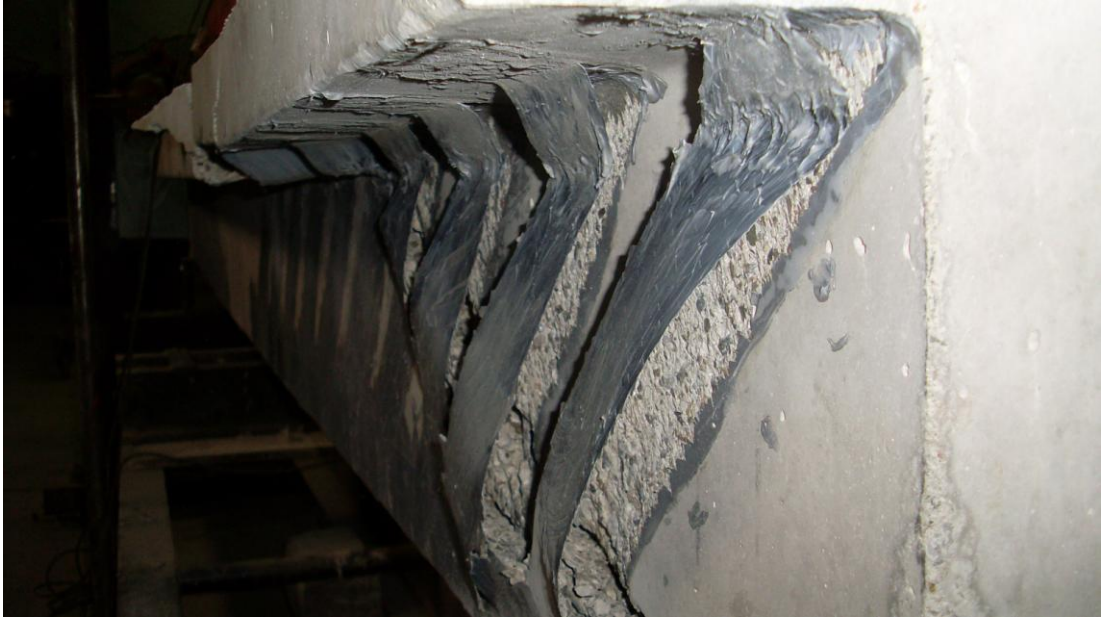
Resim 4.9. CFRP şeritlerde soyulma, deney elemanı 3
