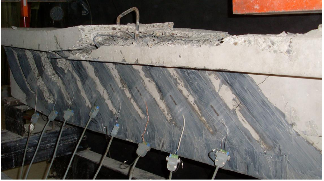
Resim 4.8. Sol kesme açıklığındaki ana kesme çatlağı, deney elemanı 3
