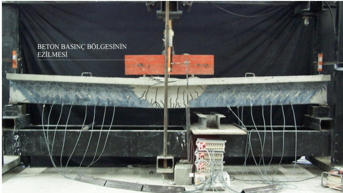
Resim 4.15. Göçme sonrası, deney elemanı 5
