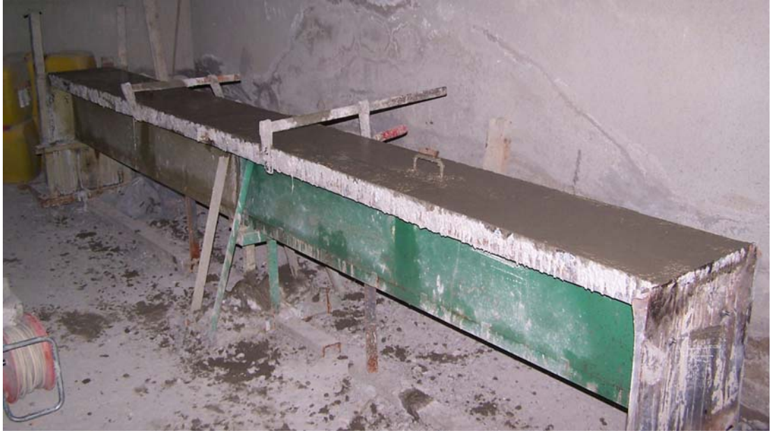
Resim 2.1. Beton dökümü tamamlanmış deney elemanı
