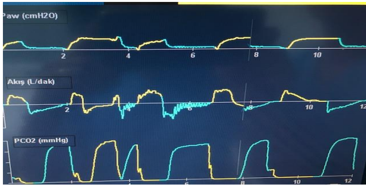
Resim:1 Akım-Zaman grafiğinde testere dişi desen (Bozan, 2019)
