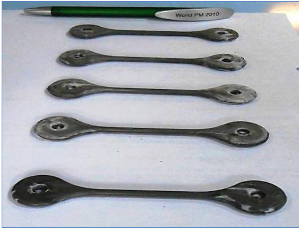
Resim 6.3. Tam dolum elde edilmiş numuneler
