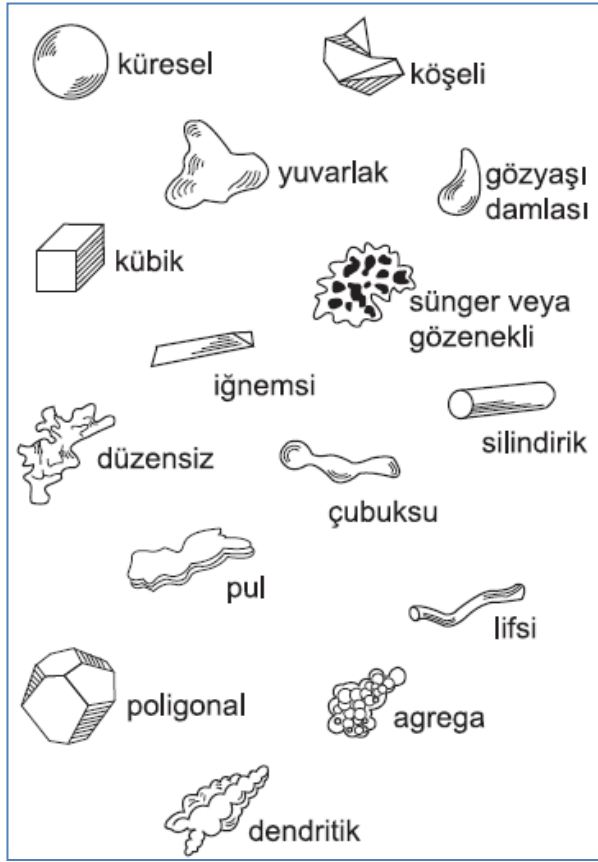
Şekil 3.16. Olası parçacık şekilleri ve önerilen niteliksel tanımlayıcılar [German, 2007]
