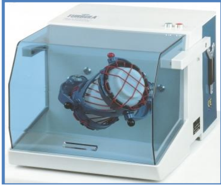
Resim 5.2. Turbula marka T2F tipi üç boyutlu karıştırıcı
