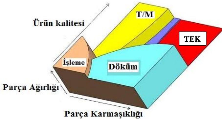
Şekil 3.13. TEK ve diğer üretim süreçlerinin karşılaştırılması[Martens, 2011]
