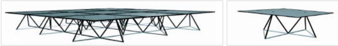
Şekil 2.3. Kagome plaka yapısı ve kagome birim hücre [28]
