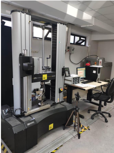
Şekil 3.13. Üç nokta eğme testlerini yapıldığı Instron 5582 cihazı
