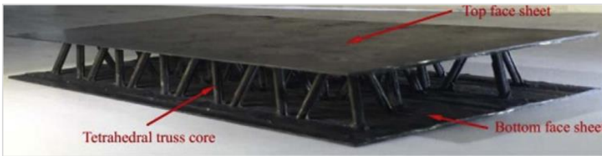
Şekil 2.19. Tipik sandviç yapı [78]
