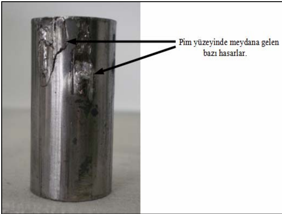
Resim 6.1. Yağlayıcı olarak grafit kullanılarak yapılan EKAP işlem sonrası hasarlı pim oluşumu.
