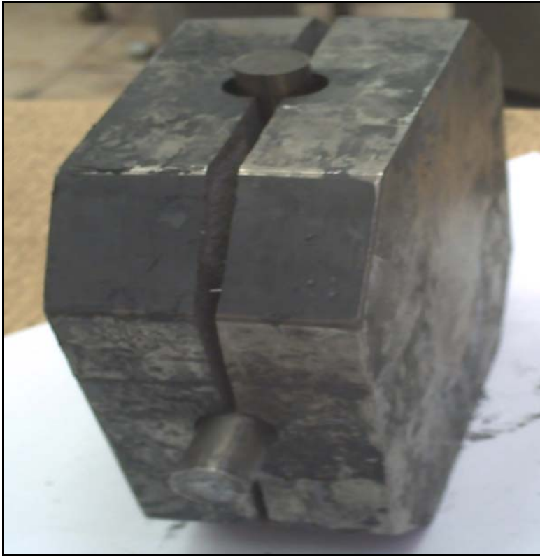
Resim 6.2. Hasarlı kalıp çekirdeği.
