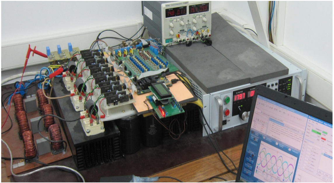
Şekil 7.50. Önerilen şebeke etkileşimli NPC eviricinin genel görünüşü
