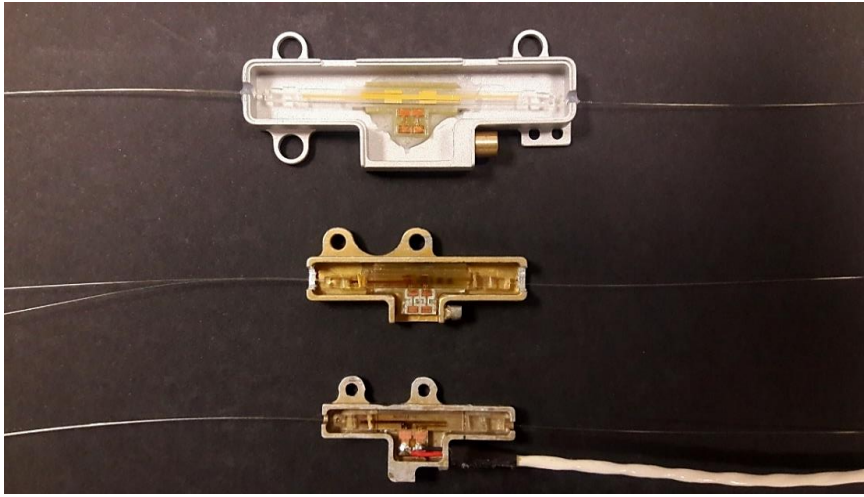
Resim 5.2. Farklı geometrik yapıda üretilen entegre optik aygıtlar
