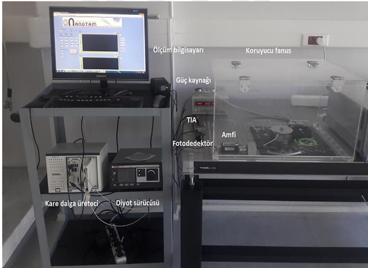
Resim 5.1. Açık döngü deney düzeneği
