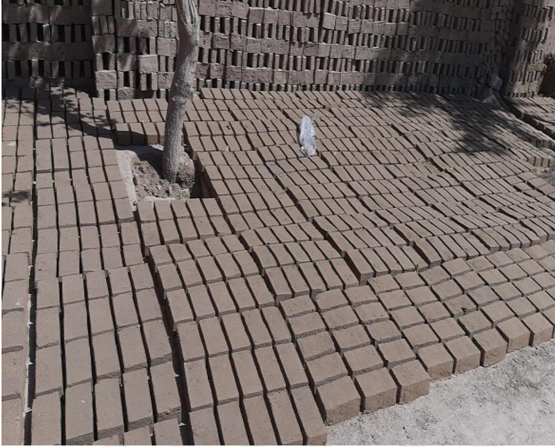
Resim 4.19. Hazırlanan tuğlaların güneş altında kurutulma aşaması üç ila dört gün veya bir hafta sürer
