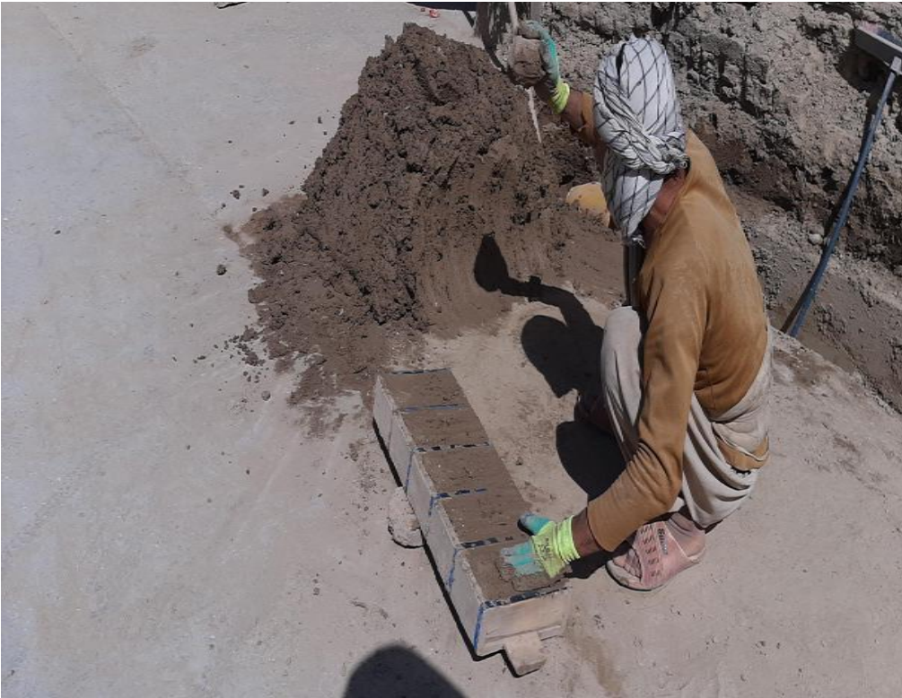
Resim 4.18. Genellikle 26, 12 ve 6,5 santimetre kalıp boyutuna sahip olan bir tuğla yapım kalıbında hazırlanmış toprağın kullanılması işlemi
