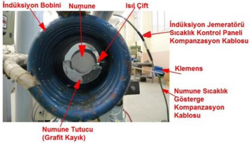
Resim 5.9. Numunenin ve ısı çiftinin indüksiyon bobini içerisindeki görünümü.
