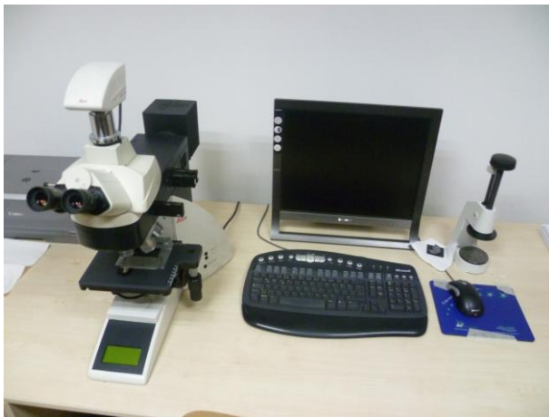
Resim 5.11. Leica DFC 320 dijital kamera bağlantılı Leica DM 4000M marka optik mikroskop.
