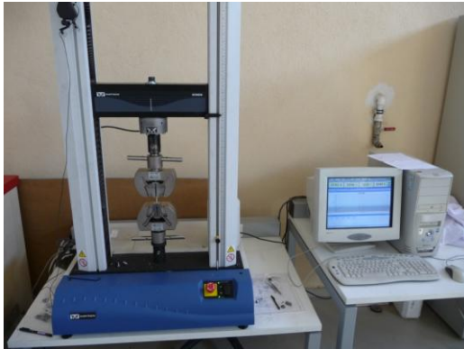
Resim 5.13. Instron 3369 model 50kN çekme ve basma kapasitesine sahip üniversal test cihazı.
