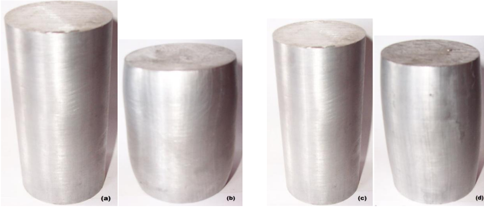
Resim 5.3. a) %30 deformasyon öncesi, b) %30 deformasyon sonrası, c) %20 deformasyon öncesi, d) %20 deformasyon sonrası numunelerin görünümü.
