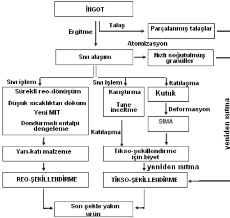
Şekil 3.2. Yarı-katı metal şekillendirme yöntemlerinin üretim aşamaları [Czerwinski, 2007, Mutlu, 2010].
