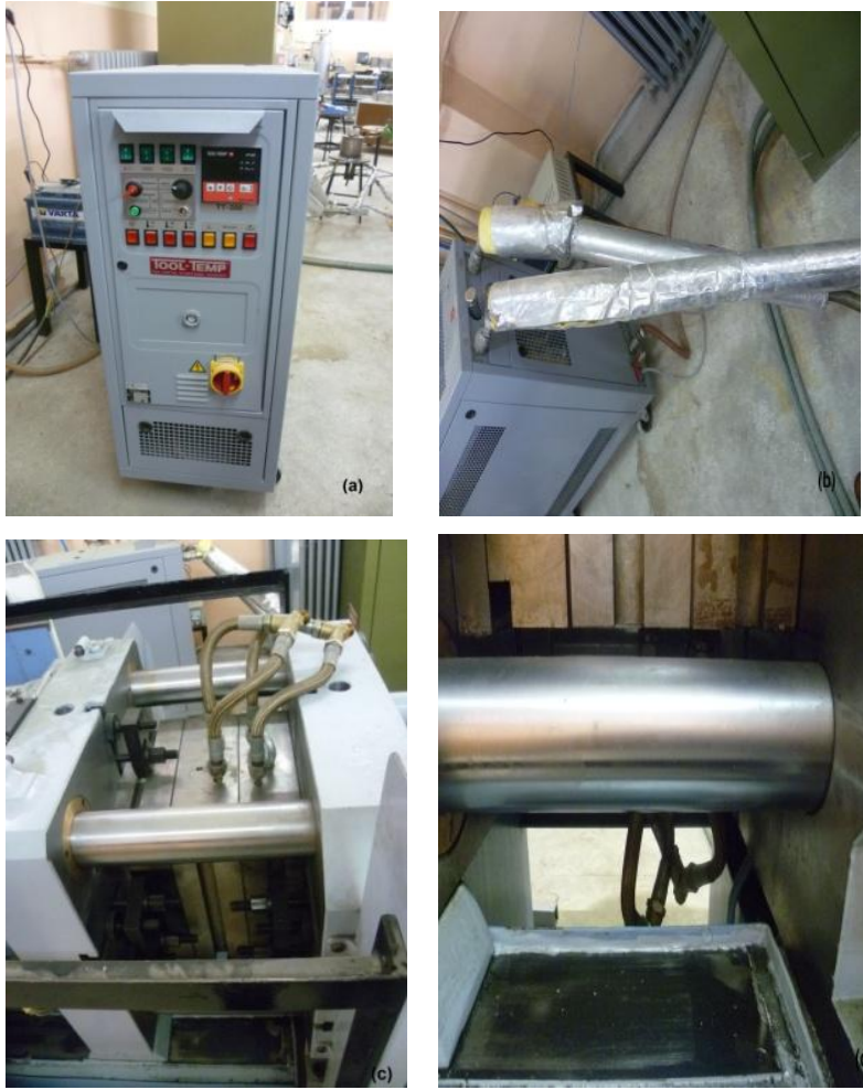
Resim 5.8. Kalıp ısıtıcısı (şartlandırıcı); a)ön panel, b)kalıp şartlandırıcı yağ giriş çıkış hortumları, c)kalıba yağ giriş hortumları, d)kalıptan yağ çıkış hortumları.
