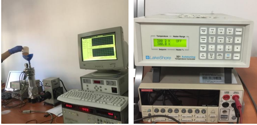
Resim 3.11. C-V ölçüm cihazları (Janis vpf-475 kriyostat ve Lake Shore 321 Autotuning Temperature Controller cihazları) (Gazi Ü. Fotonik Lab.)
