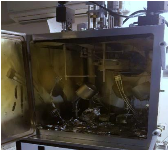
Resim 3.4. Saçtırma sistemi (Nanovak NVTS 500 Eş Saçtırma Sistemi) (Gazi Üni. Fotonik Lab.)
