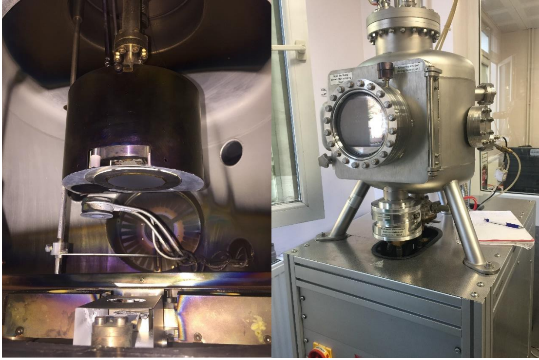
Resim 3.5. Termal buharlaştırma sistemi (Bes Tec Termal Buharlaştırma Sistemi) (Gazi Üni. Fotonik Lab.)
