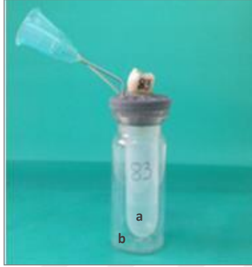
Resim 3.5. Myers ve Montgomery'nin tekniğine göre hazırlanmış deney düzeneği. a) Eppendorf tüp b) tüpü dış etkenlerden koruyan cam şişe. 21 G iki adet enjektör iğnesi dış ve iç basıncı dengelemek amacıyla tıpayı saplandı.
