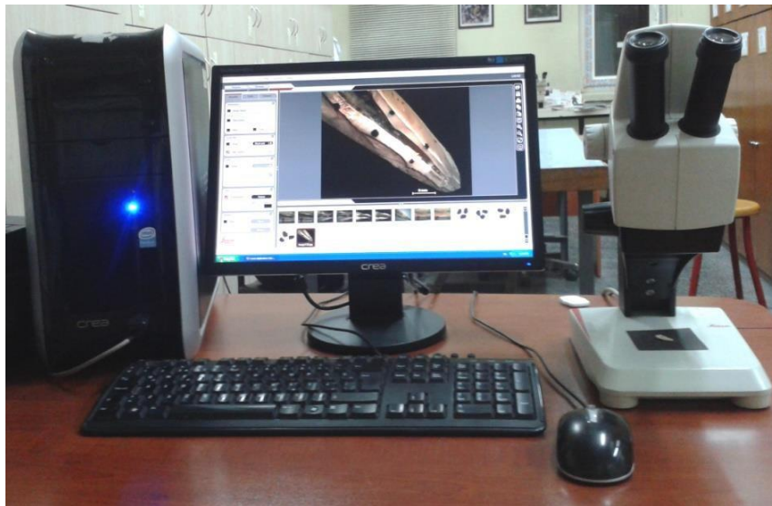
Resim 3.7. Yüzey temizliğini değerlendirmede kullanılan stereomikroskop düzeneği
