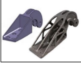
Resim 2.7. Topoloji optimizasyonu yapılarak imal edilen bir braket [12]
