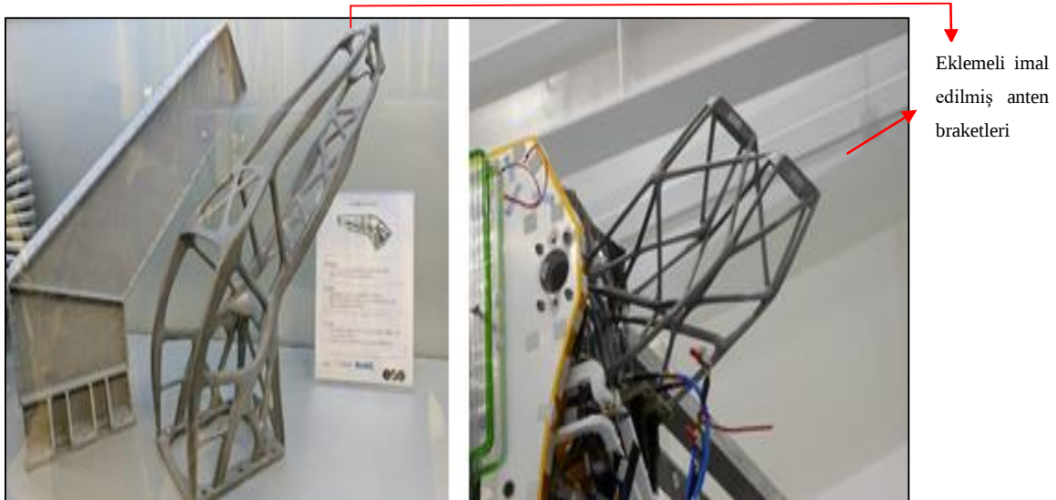
Resim 2.1. Eklemeli imalat anten braketleri Airbus (solda), KARI (sağda) [4,5]
