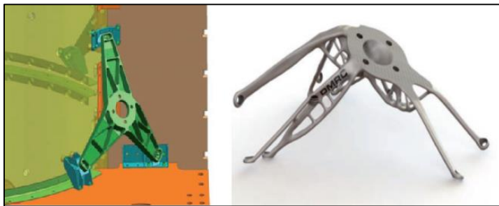
Resim 2.20. Tepki tekeri braketinin eklemeli imalat çalışması, DMRC [27]
