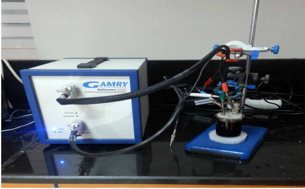
Resim 4.7. Elektroliz işlem uygulaması
