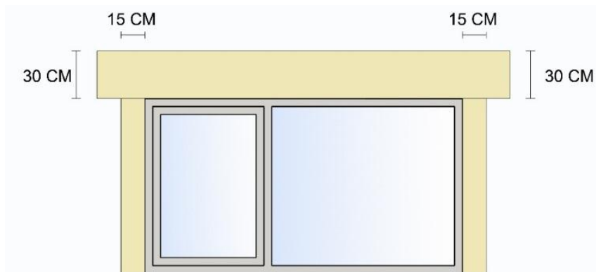
Şekil 5.1. BYKHY kapsamında cephe açıklıklarında yangın bariyeri kullanımı
