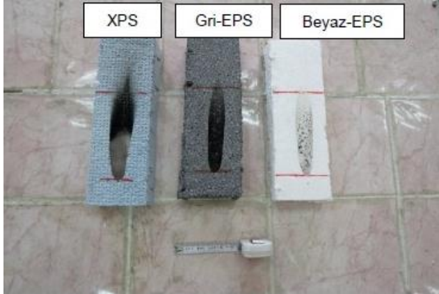
Resim 4.1. Isı yalıtım malzemelerinin yangına tepkisinin belirlenmesi [132]
