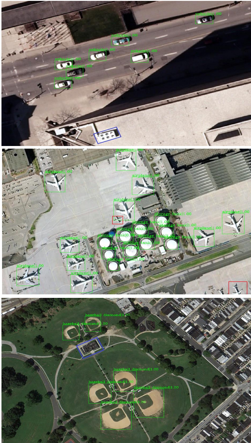
Şekil 5.21 Katsayı Ağırlıklı Topluluk Nesne Tespit modelinin NWPU-VHR10 veri seti üzerindeki nesne tespit sonuçları
