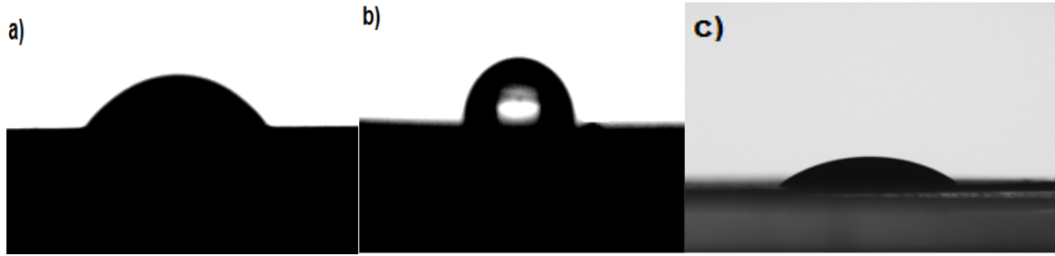
Resim 4.3. a) Nanoküre-TiO 2 b) Nanoküre-TiO 2 -APTS c) Nanoküre-TiO 2 /PPy Temas Açısı Görüntüleri
