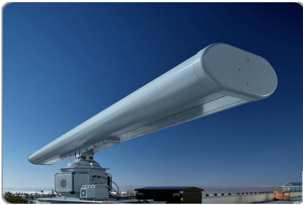
Resim 3.2. SERDAR sahil gözetleme radarı (Vizyoner Genç, 2020)
