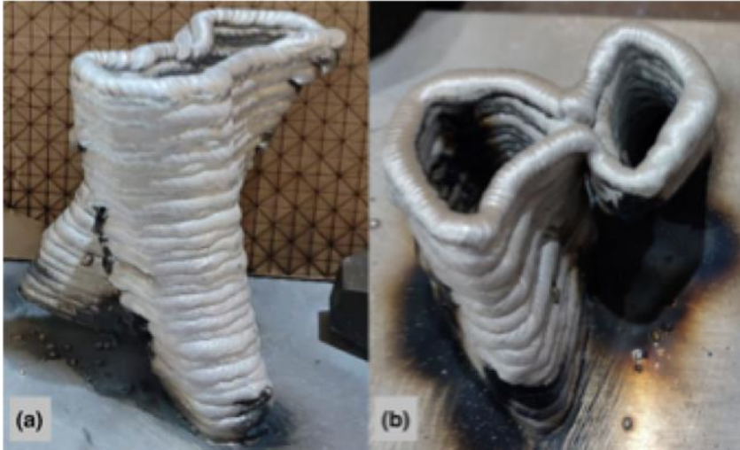
Resim 2.2. (a) İmal edilmiş serbest biçimli parça (b) bağlantı noktası [4]
