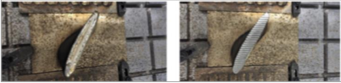
Resim 2.6. (a) Talaşlı işlemden önce basılmış yüzey, (b) talaşlı işlemden sonra basılmış yüzey [6]
