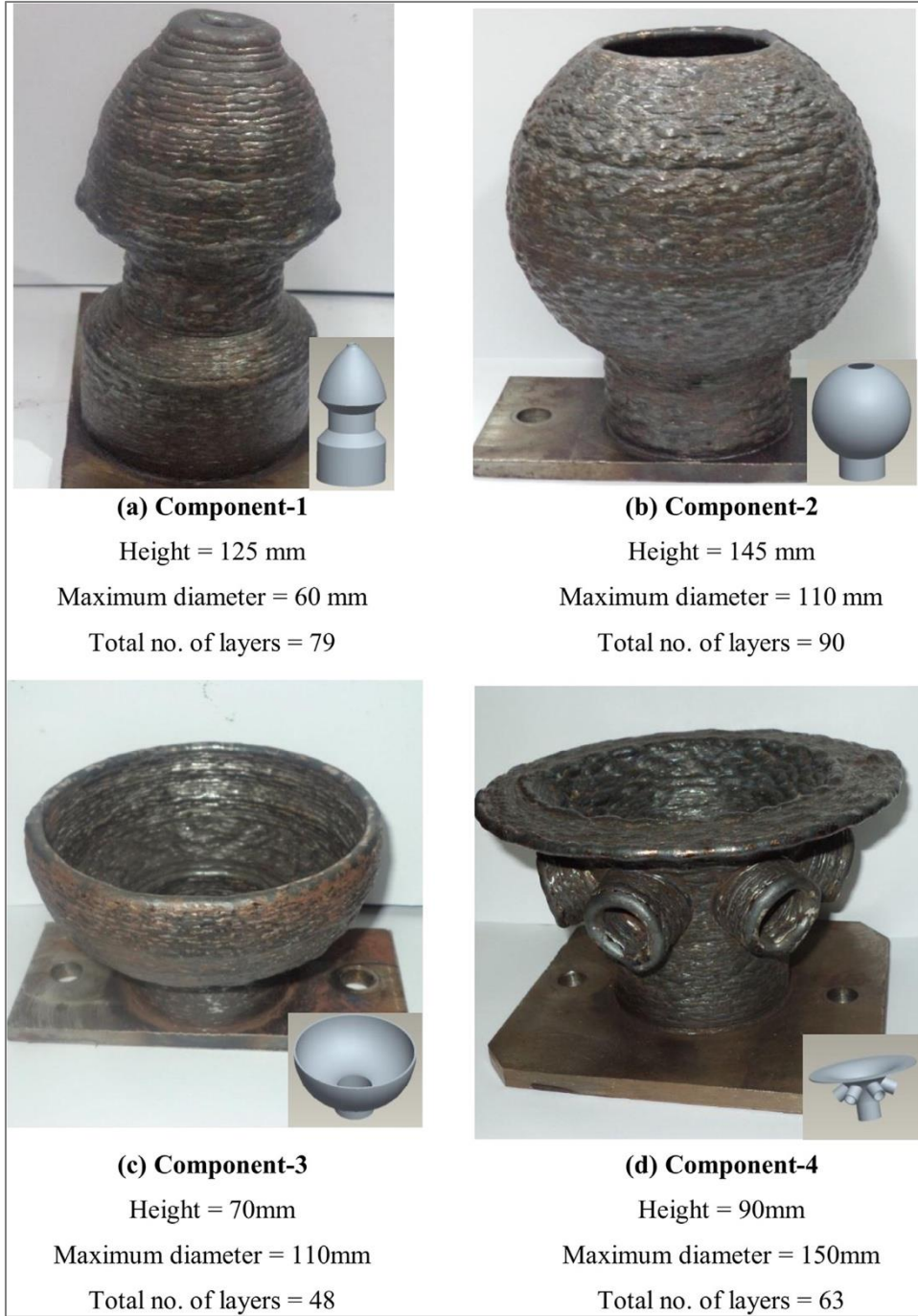
Resim 2.29. 5-eksenli eğimli biriktirme kullanılarak üretilen karmaşık ince duvarlı bileşenler [29]
