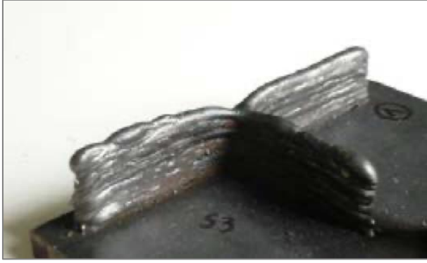
Resim 2.10. Strateji-3 ile imal edilmiş T-geçiş, merkezi bölgede biriktirme başarısızlığı var [12]
