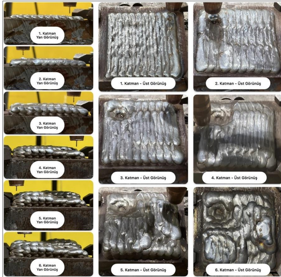
Resim 5.5. Hexagrid takım yolu stratejisi ile imal edilen parçanın tüm katmanlarının yandan ve üstten görünüşleri
