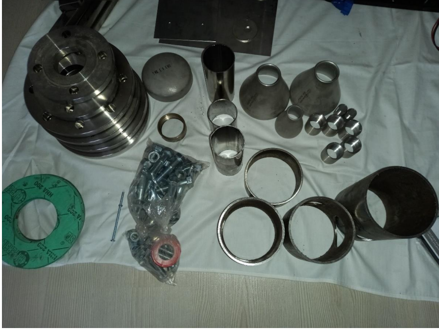
Resim 3.1. Gazlaştırıcı gövdesinin üretiminde kullanılan standart paslanmaz parçalar ve contalar.
