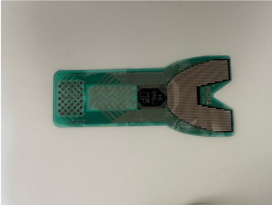
Resim 3.1. T-scan III hassas sensör
