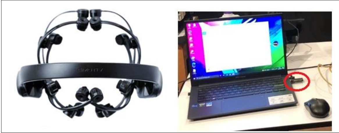
Resim 4.1. EMOTIV EPOC X EEG başlığı ve USB aparatı
