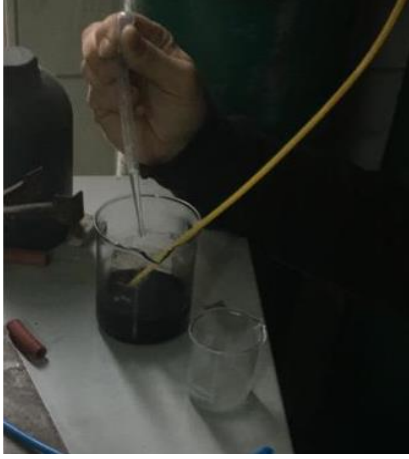
Resim 4.1. Numunenin azot atmosferi altında karışımının görünümü
