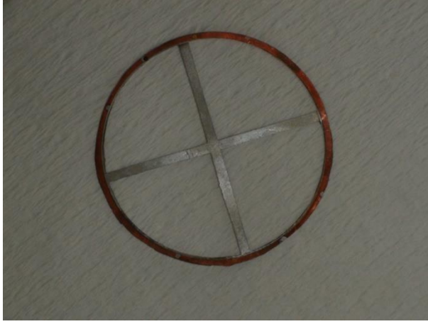
Resim 3.6. Omik kontağın oluşturulması için kullanılan metal maske
