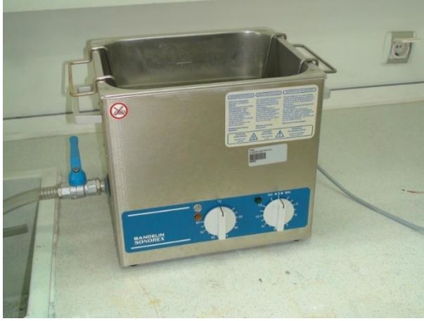
Resim 3.2. Beher Bandelin Sonorex marka ultrasonik banyo
