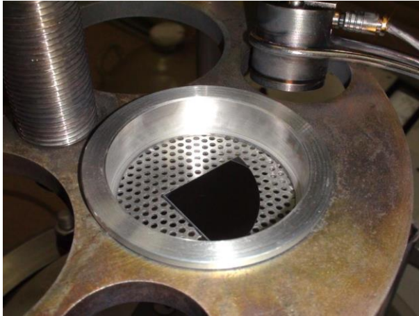
Resim 3.7. Numune tutucu içerisine maske ile yerleştirilmiş silisyum kristali
