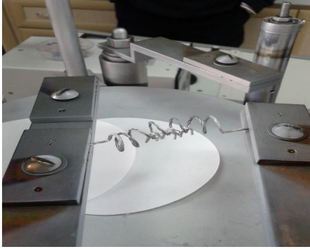
Resim 3.8. Buharlařtırma iřleminde kullanılan tungsten pota
