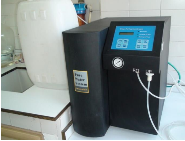
Resim 3.3. “Innovation Water Purification” marka deiyonize su sistemi
