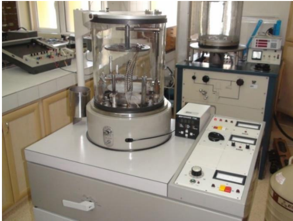
Resim 3.5. Au/n-Si/Al Schottky diyotların hazırlanması için kullanılan “Edwards” marka buharlaştırma sistemi
