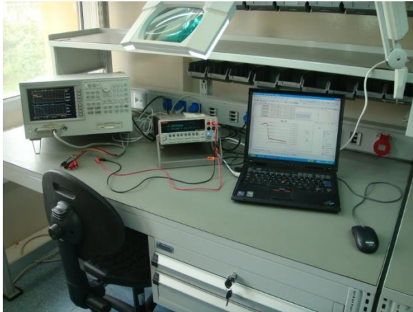
Resim 3.14. Bilgisayar kontrollü HP Agilent 4294A Precision Impedance Analyzer (soldaki) ve Keithley 2400 Source Meter (sağdaki) cihazları
