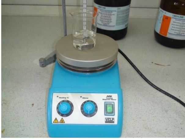
Resim 3.4. Kristal temizliği aşamasında kullanılan ısıtıcı düzeneği
