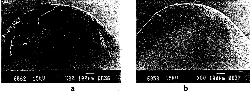
Şekil 6.52. 88 ve 110 m.dk -1 kesme hızlarında BS745 numunelerinde oluşan talaş kökü (a. 88 m.dk -1 , b. 110 m.dk -1 )
