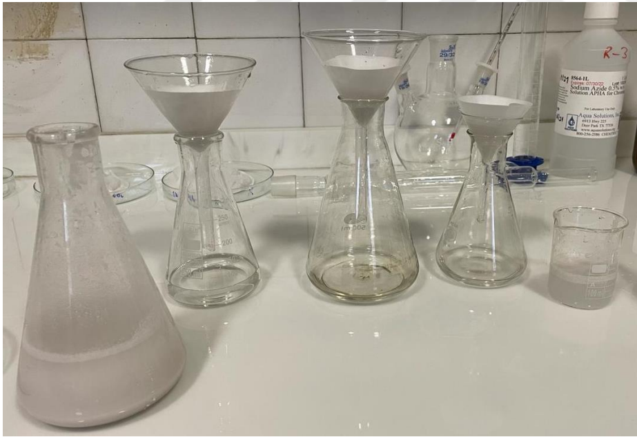
Resim 4.3. Perliti yıkama işlemi
