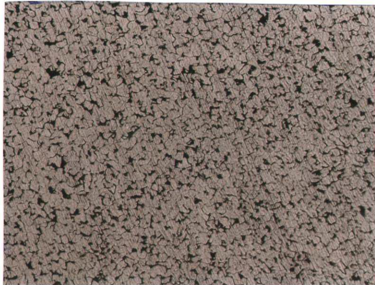
Şekil 6.2. Ç1010 soğuk çekilmiş malzemenin çekme yönüne dik mikroyapısı \times 100
