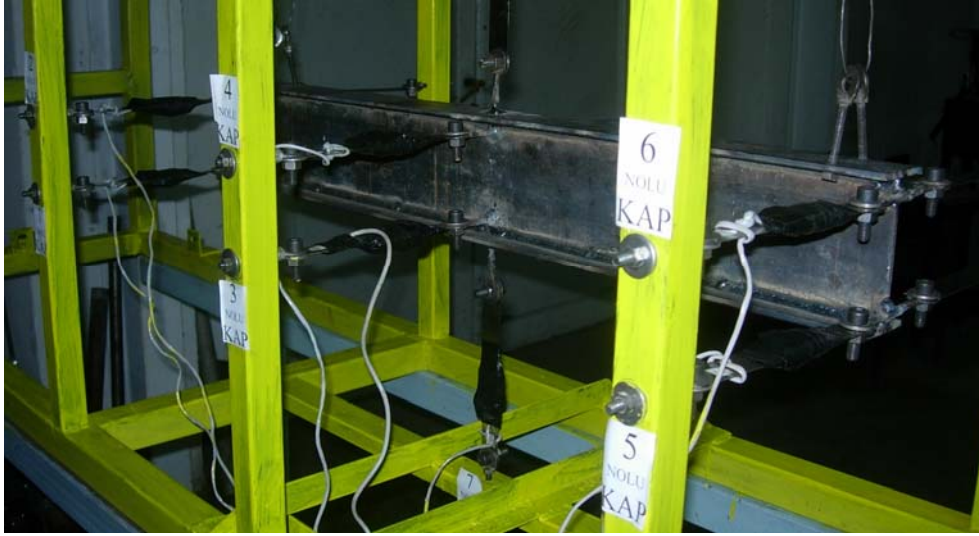
Resim 5.2. Deney numunesi ve kuvvet algılayıcı plakalar
