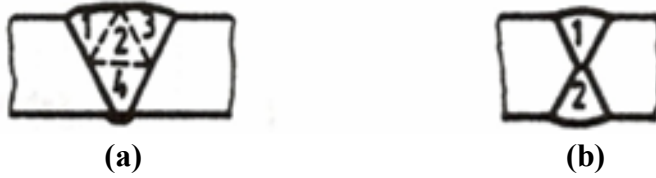
Şekil 4.36. V kaynak ağzı ile X kaynak ağzı için gerekli kaynak metalinin karşılaştırılması a) Tek taraflı 'V' kaynak ağzı b) Çift taraflı 'V' kaynak ağzı
