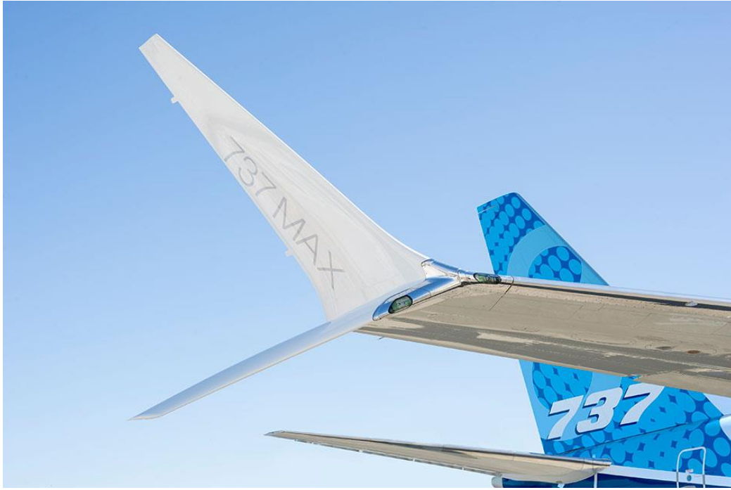
Şekil 3.4. Boeing'in yakıt tasarrufu ve düşük emisyon sağlayan kanat ucu kıvrım tasarımı (winglet) [65]
