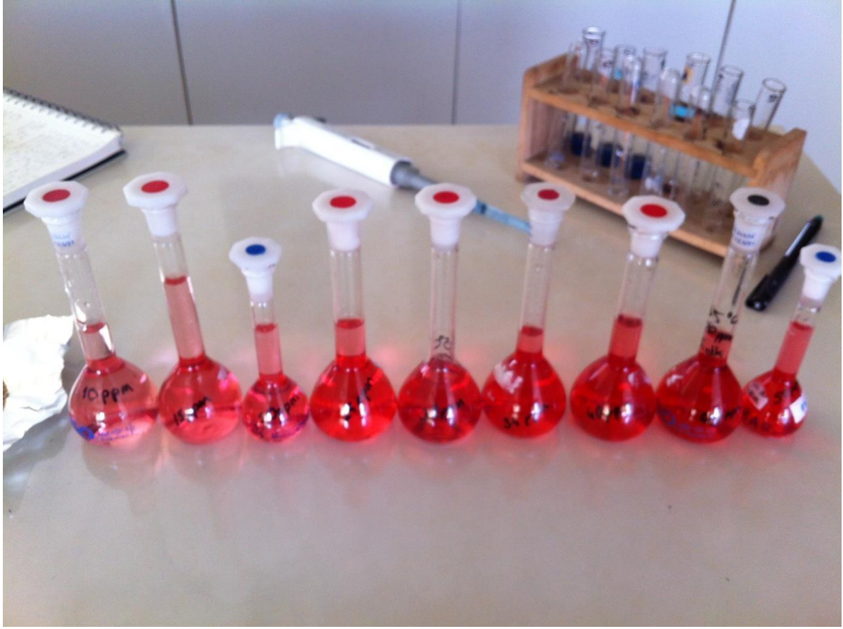
Şekil 2.1 Kalibrasyon eğrisi için hazırlanan çözeltiler (10, 15, 20, 25, 30, 35, 40, 45, 50 ppm'lik)
