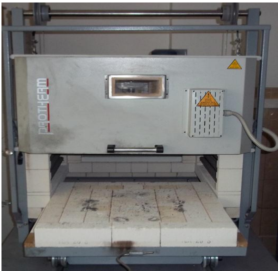
Resim 6.4. Özel olarak metalik köpük üretimi için tasarlanmış protherm marka fırın
