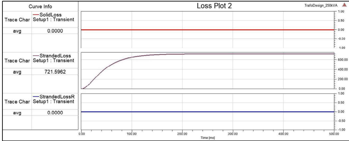
Resim 4.57. Transformatörün tam yük çalışmasında elde edilen kayıplar
