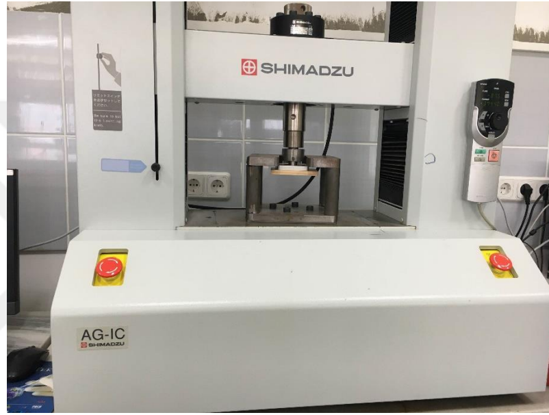
Fotoğraf 4.7 Üniversal test cihazı ve yüzeye yapışma direnci deney düzeneği
