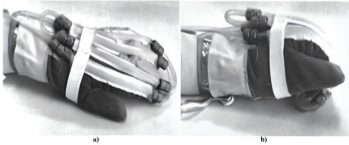
Resim 2.12. ŞHA telli eldivenler: a) Düşük sıcaklıktaki pozisyon b) Yüksek sıcaklıktaki pozisyon [28]
