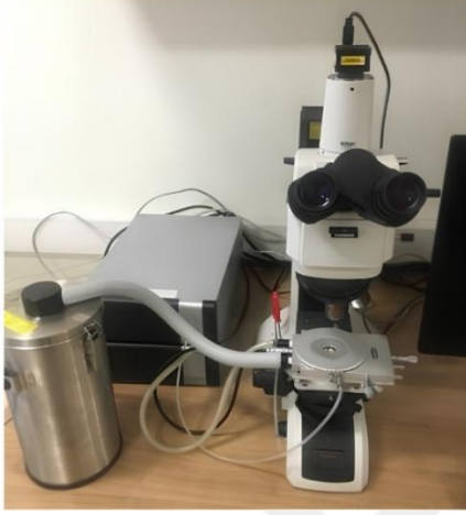
Resim 3.3. Nikon Eclipse LV100ND endüstriyel mikroskop ve -196\text{ }^{\circ}\text{C} ile +600\text{ }^{\circ}\text{C} arasında görüntü alınabilen Linkam THMS600 ısıtıcı tabla
