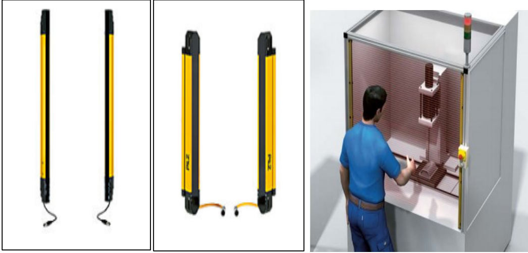
Resim 4.10. Opto-elektronik koruma cihazı [47] ve tehlikeli noktaya erişilmeden parmakların veya elin algılanması [48]
