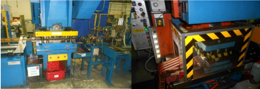
Resim 4.5. Operasyon noktasına temasın önlenmesi – öncesi – sonrası
