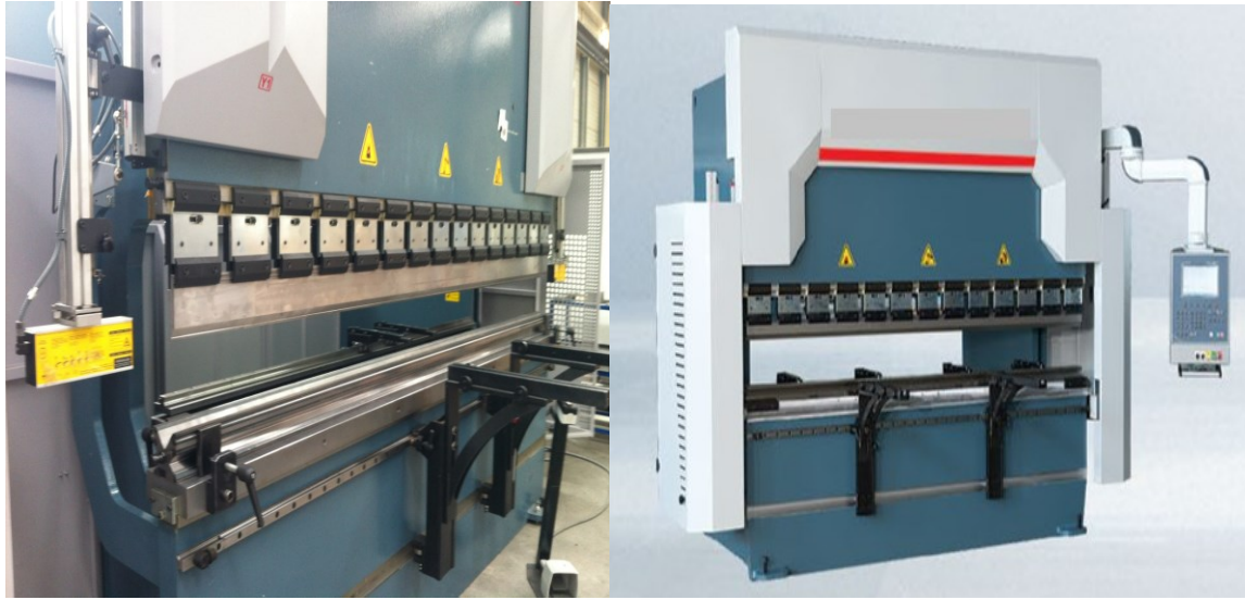
Resim 4.6. Hidrolik abkant preste operasyon noktası önlemleri [43]
