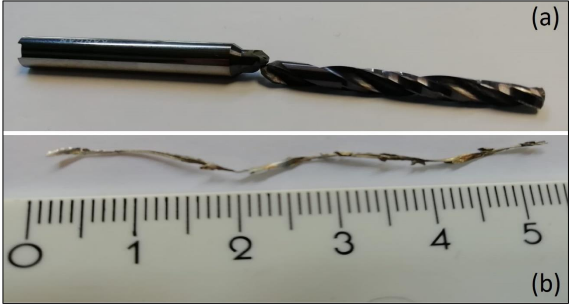
Şekil 5.17. (a) Kırılan ikinci takım ve (b) talaşı
