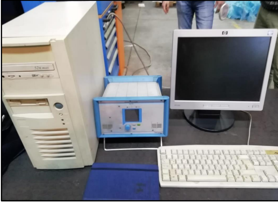
Şekil 4.16. Ölçümde kullanılan bilgisayar ve Kistler 5070 amplifier
