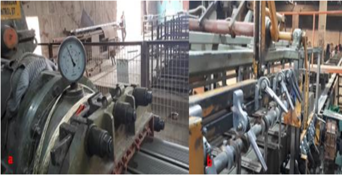
Resim 3.9. (a) Vakum pres makinesi ile kalıptan çıkması, (b) Tuğlaların tel sistemi ile kesimi
