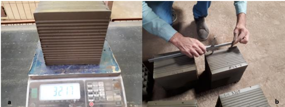
Resim 3.15. (a) Yaş tuğlaların tartılması, (b) Yaş tuğlaların kumpasla işaretlenmesi
