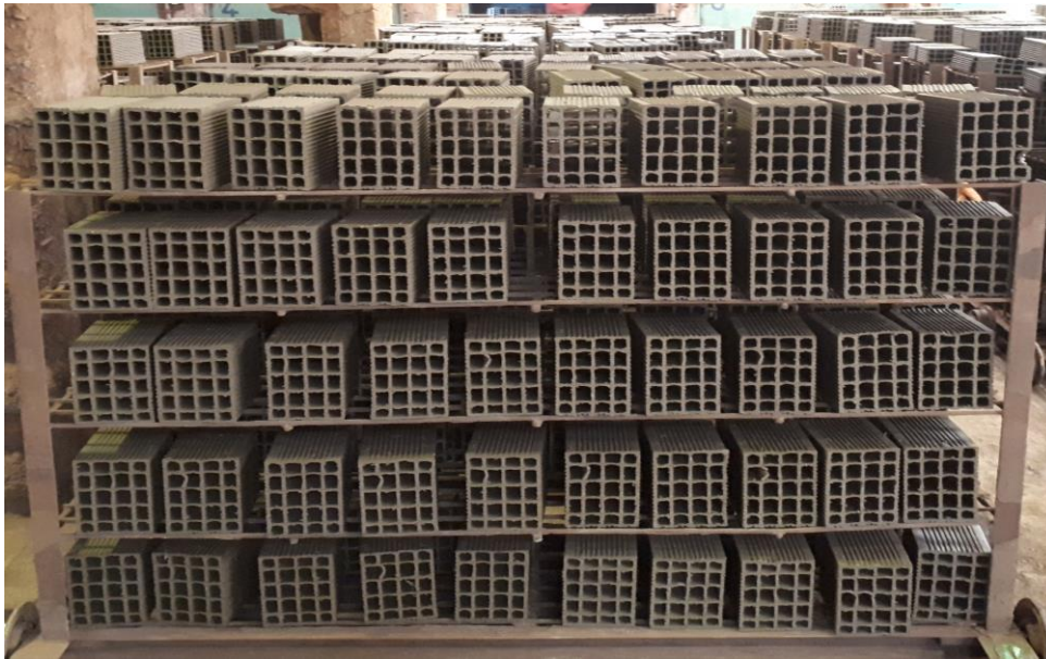
Resim 3.11. Kurutma odalarına girmeye hazırlanan tuğlalar
