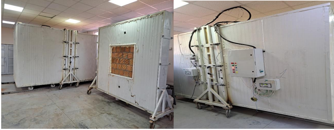
Resim 3.21. Hot-Box ısıl geçirgenlik deney seti görünümü
