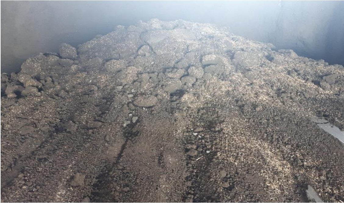
Resim 3.5. Karıřtırılmıř kil ve eltik kavuzunun beřigerdeki grnts
