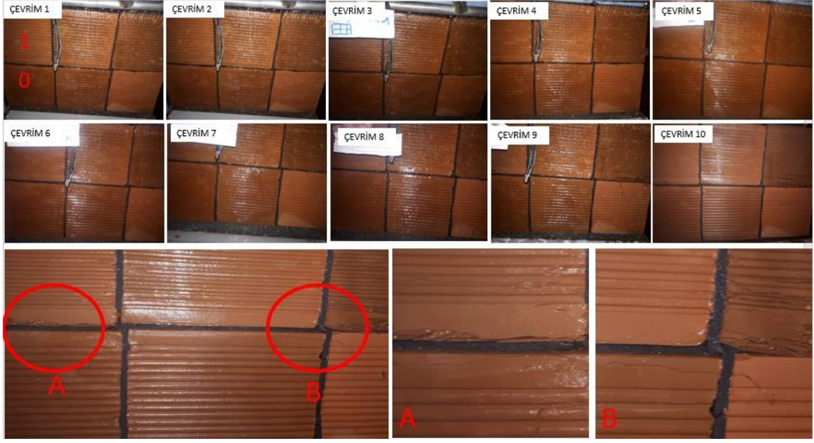
Resim 4.5. %0 ve %2,5 ÇK katkıli tuğla örneklerinin donma çözülme çevrimleri
