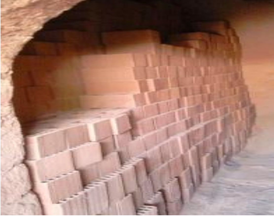
Resim 3.13. Fırında pişmiş tuğlalar
