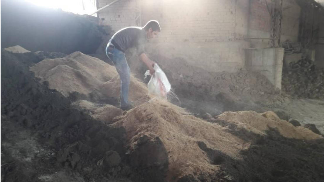
Resim 3.3. Yere serilmiş dinlendirilmiş kilin üzerine çeltik kavuzunun dökülmesi
