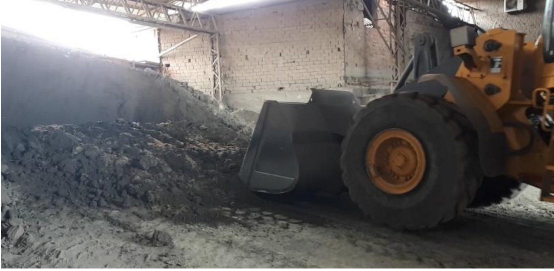
Resim 3.4. Kil ve eltik kavuzunun ykleyici kepe ile karıřtırılması
