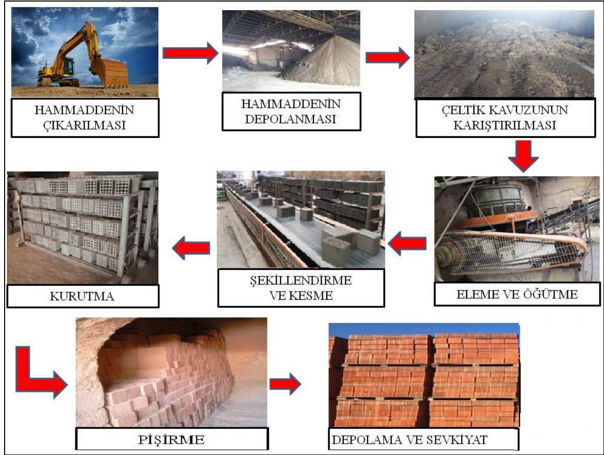
Resim 2.1. Çeltik kavuzu katkılı tuğla üretim süreçleri
