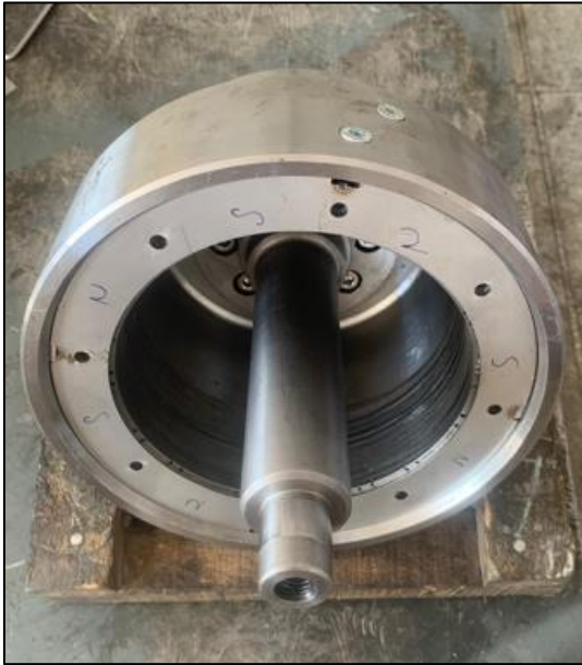
Resim 6.23. Rotor paketlerinin rotor tutucu parçaya yerleştirilmesi
