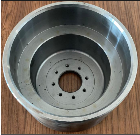
Resim 6.15. Teknik resme uygun üretilmiş rotor tutucu
