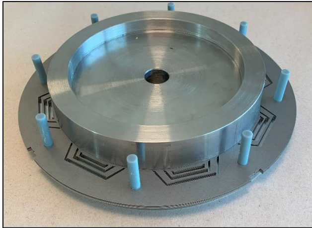
Resim 6.5. Rotor laminasyonlarının aparat yardımı ile dizilmesi
