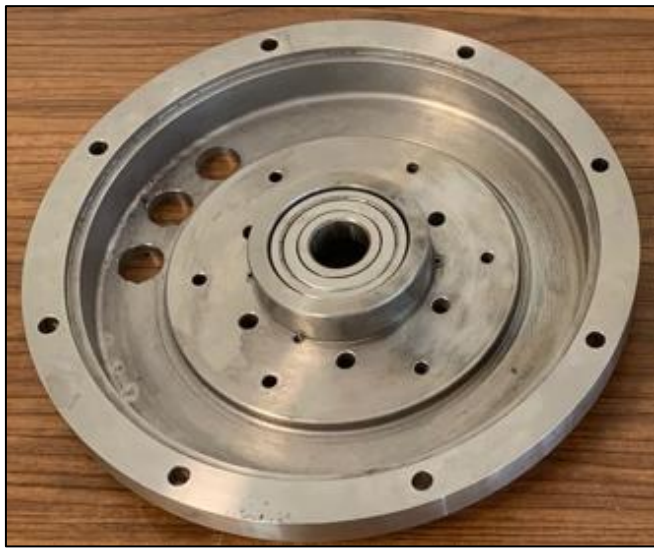
Resim 6.18. Rulman yerleştirilmiş arka kapak
