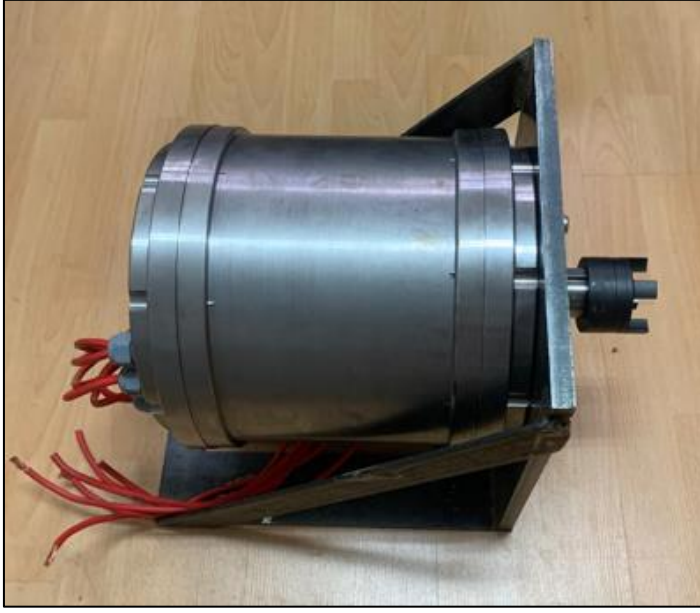
Resim 6.26. Tamamlanmış motor montajı
