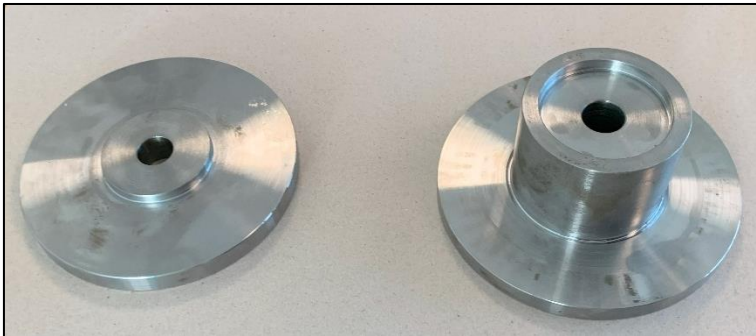
Resim 6.3. Stator dizme ve sıkıştırma aparatı
