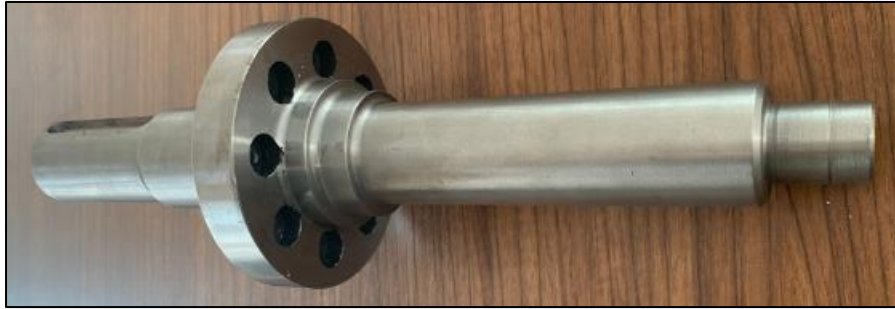
Resim 6.12. Teknik resme uygun üretilmiş motor mili
