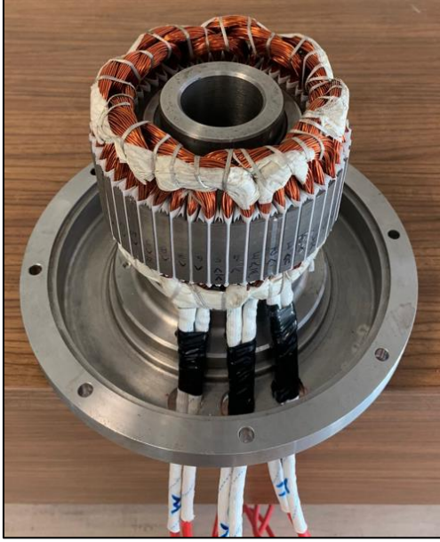
Resim 6.20. Arka kapak ve stator tutucu parçanın montajı
