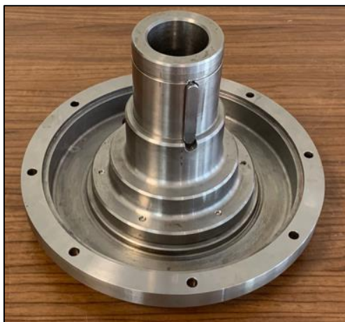
Resim 6.19. Arka kapak ve stator tutucu parçanın montajı
