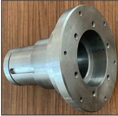
Resim 6.16. Teknik resme uygun üretilmiş stator tutucu
