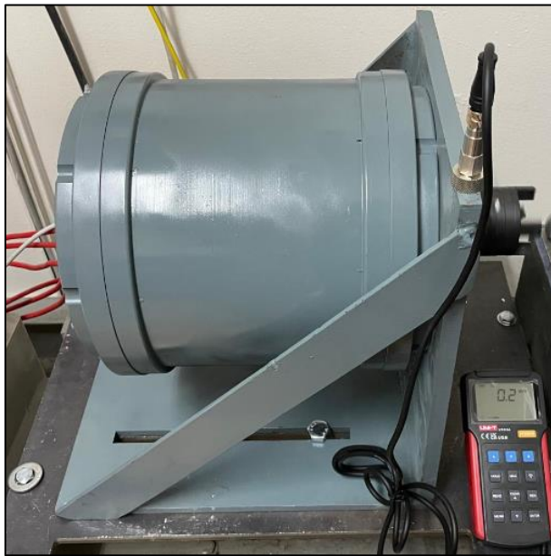
Resim 7.8. MD-SRM Titreşim testi düzeneği
