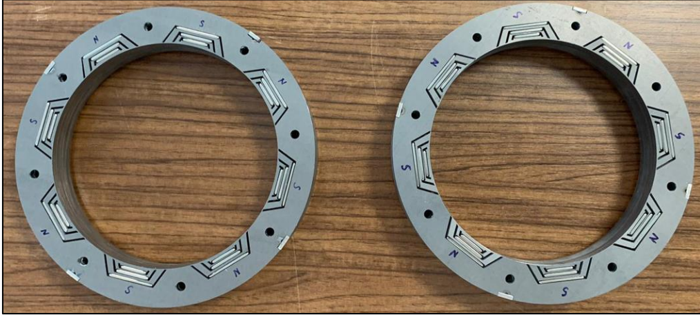
Resim 6.22. Mıknatıs montajı yapılan rotor paketleri
