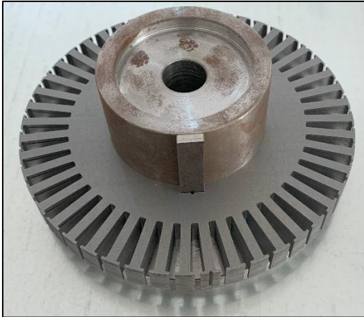
Resim 6.7. Stator laminasyonlarının aparat yardımı ile dizilmesi
