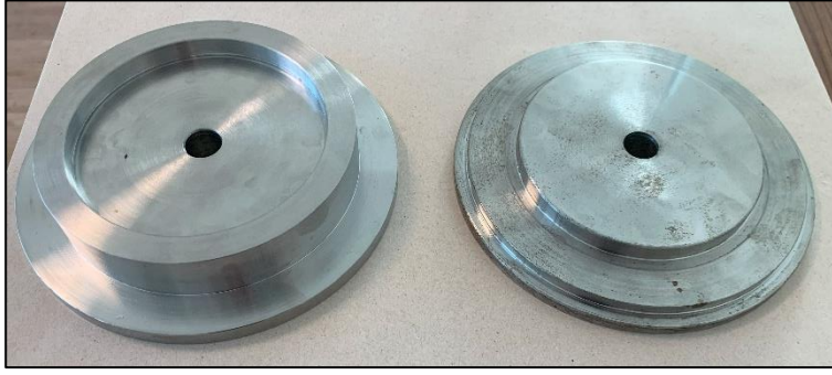
Resim 6.4. Rotor dizme ve sıkıştırma aparatı
