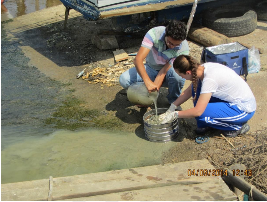
Resim 3.4. Bentik materyalin elekler yardımıyla süzülmesi işlemi
