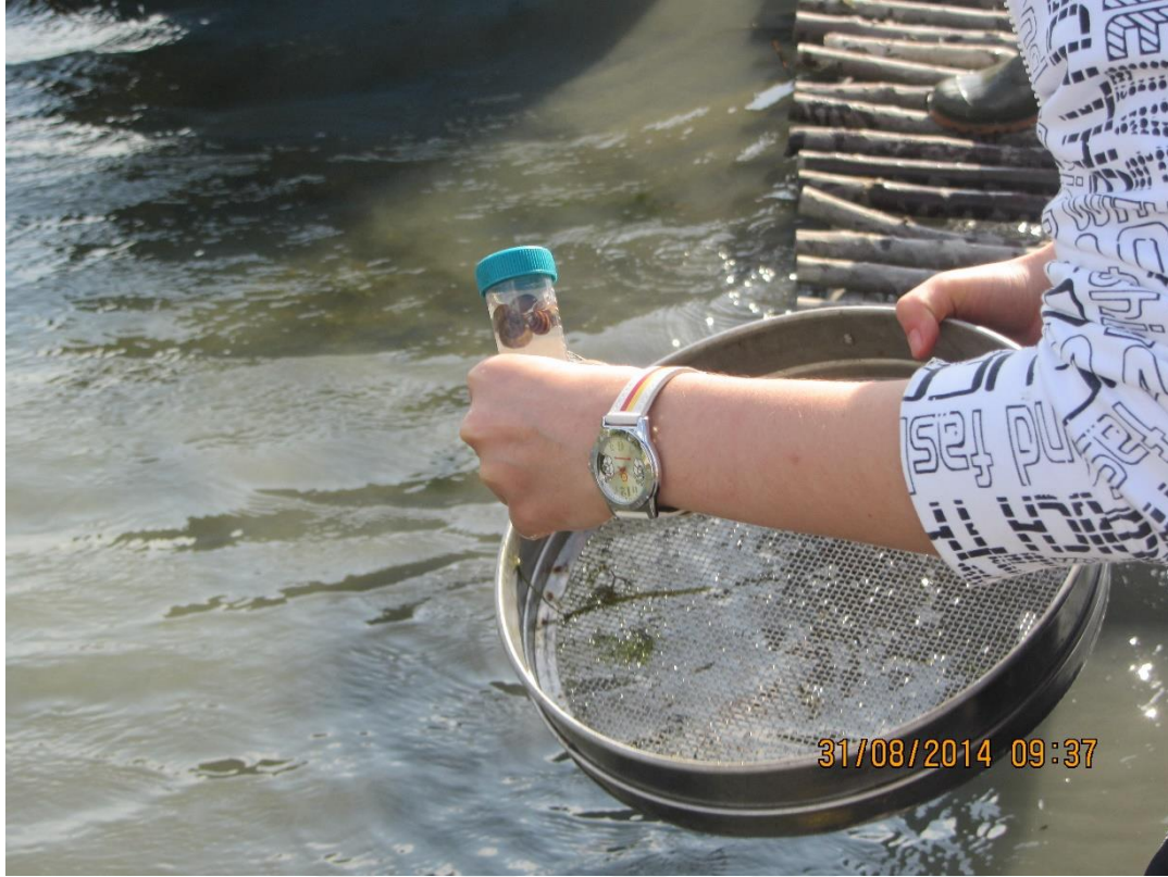
Resim 3.2. Elek üzerinde kalan örneklerin numune kabına alınması
