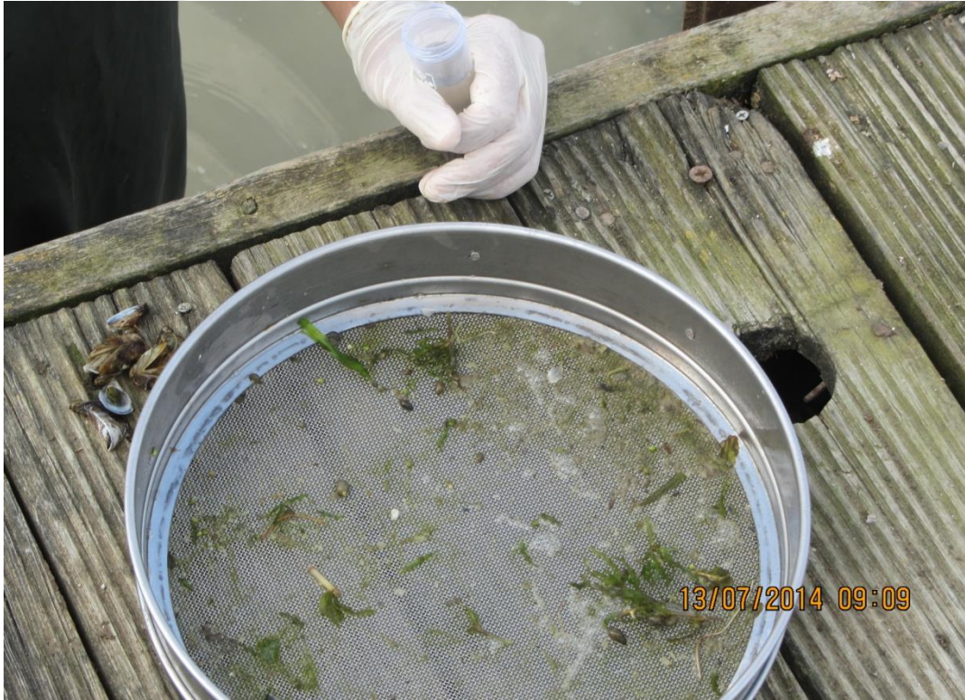
Resim 3.5. Bentik örneklerin %70'lik alkol bulunan numune kabına alınması
