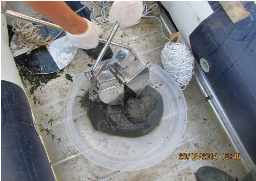
Resim 3.3. Bentik materyalin toplanması için kullanılan Ekman Kepçesi
