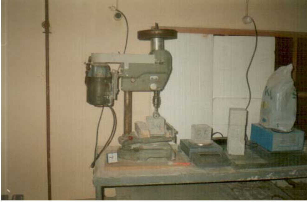
Resim 3.5. Betonların aşınma deneyinde kullanılan Rotating Cutter cihazının görünüşü
