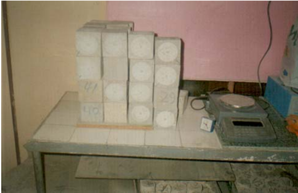
Resim 3.6. Beton numunelerinin aşınma deneyinden sonraki görünüşleri
