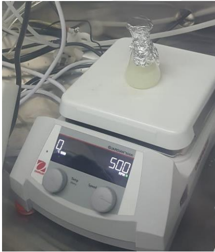
Şekil 6.1. Guardian ısıtıcı üzerinde 500 rpm de Nb 2 O 5 çözeltisi
