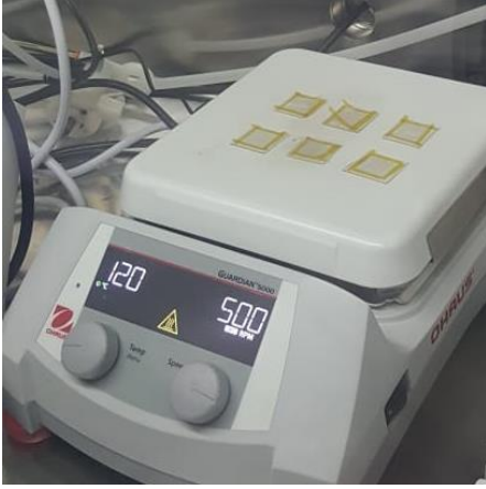
Şekil 6.3. Nb 2 O 5 çözeltisi ile kaplanan numunelerin ısıtıcıda 120°C bekletilme prosedürü
