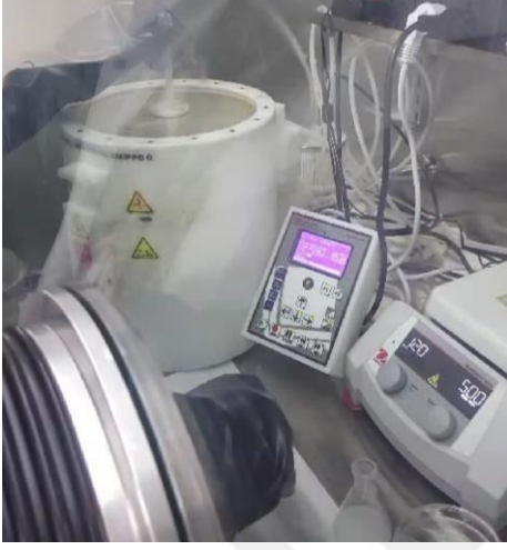
Şekil 6.2. Spin coater cihazında Nb 2 O 5 çözelti alttaş üzerine damlatılarak kaplanması
