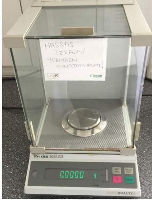
Şekil 3.5. Kullanılan pata %0.1 oranında Rodamin-B ilave edilirken kullanılan hassas tartı
