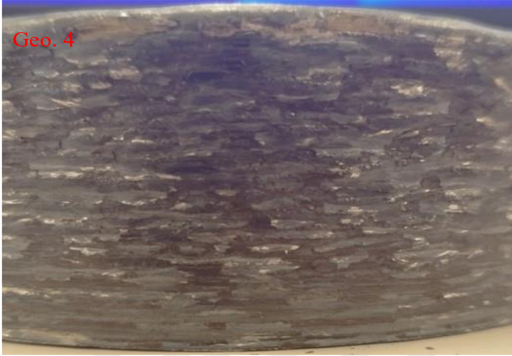
Şekil 5.29. Harici ısı kaynaklı WAAM parçasının yüzey görünümü: yüzeydeki katman profili ve katmanlı yapının detayları
