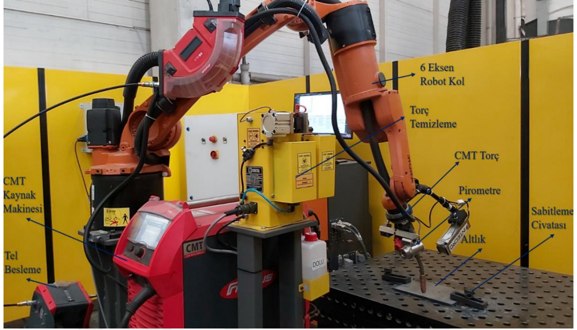
Şekil 4.1. Deneysel çalışmada kullanılan WAAM altyapısı
