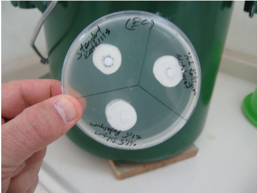
Resim 5.1. EC aşılannış katkısız, %1 kalsiyum metaborat katkılı ve %1,5 potasyum metaborat+%1,5 sodyum tetraborat katkılı boya numunelerinin antibakteriyel etkinliklerinin tayini
