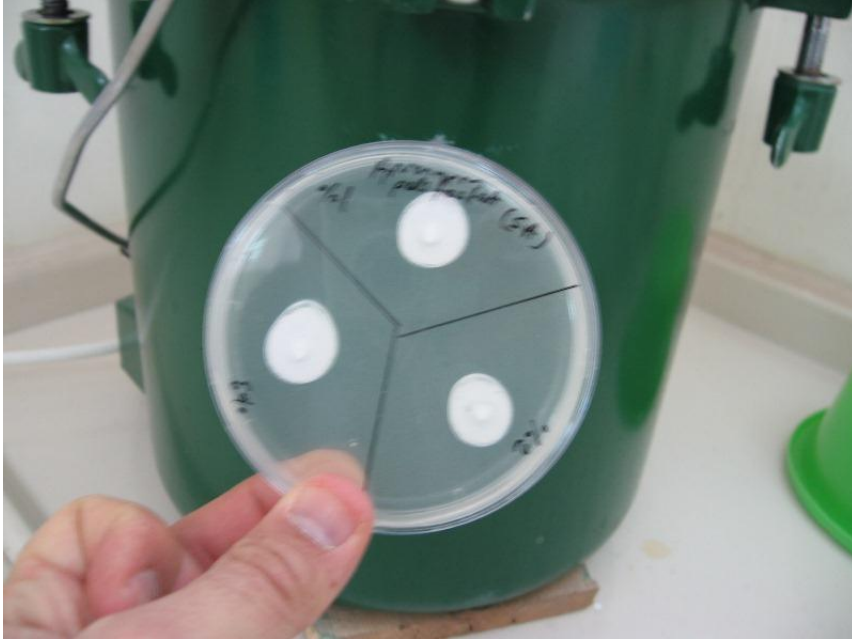
Resim 5.8. SA aşılannmış, %1, 2 ve 3 amonyum polifosfat katkılı boya numunelerinin antibakteriyel etkinliklerinin tayini
