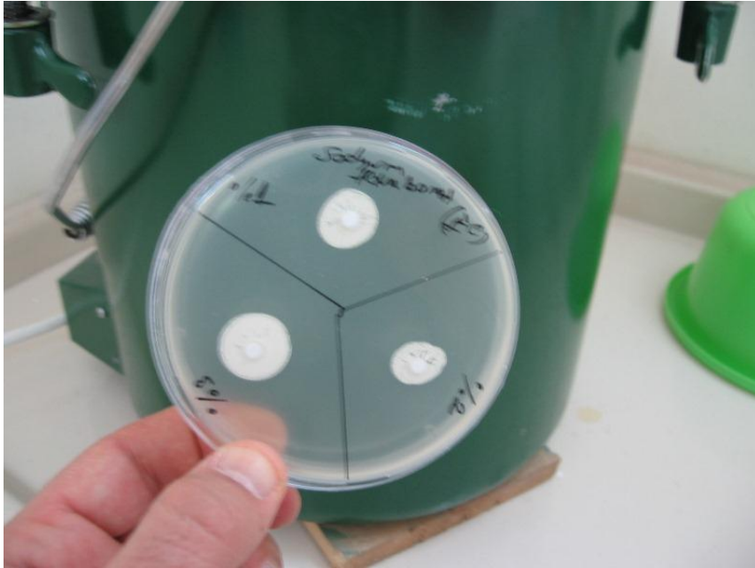
Resim 5.4. SA aşılانmış %1, 2 ve 3 potasyum metaborat katkılı boya numunelerinin antibakteriyel etkinliklerinin tayini
