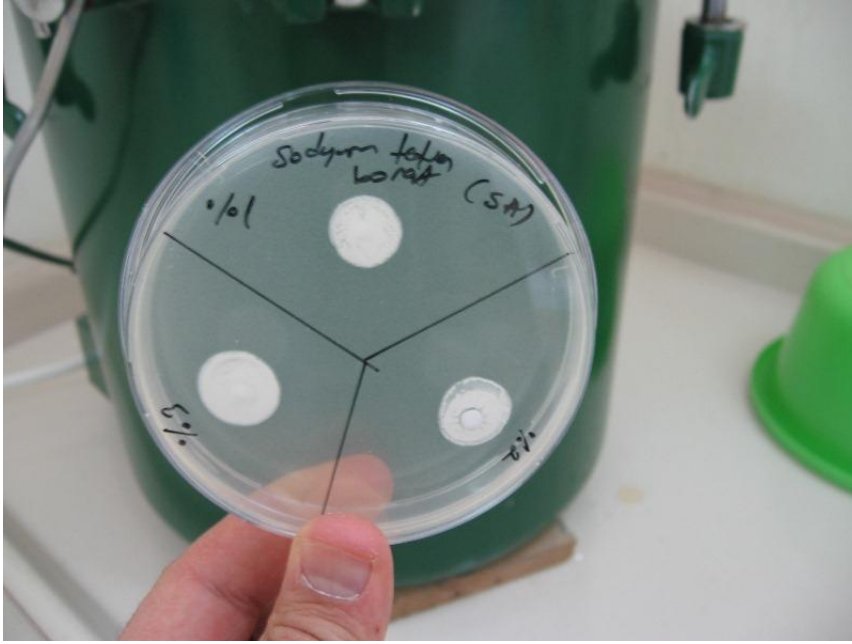
Resim 5.6. SA aşılannış %1, 2 ve 3 sodyum tetraborat katkılı boya numunelerinin antibakteriyel etkinliklerinin tayini
