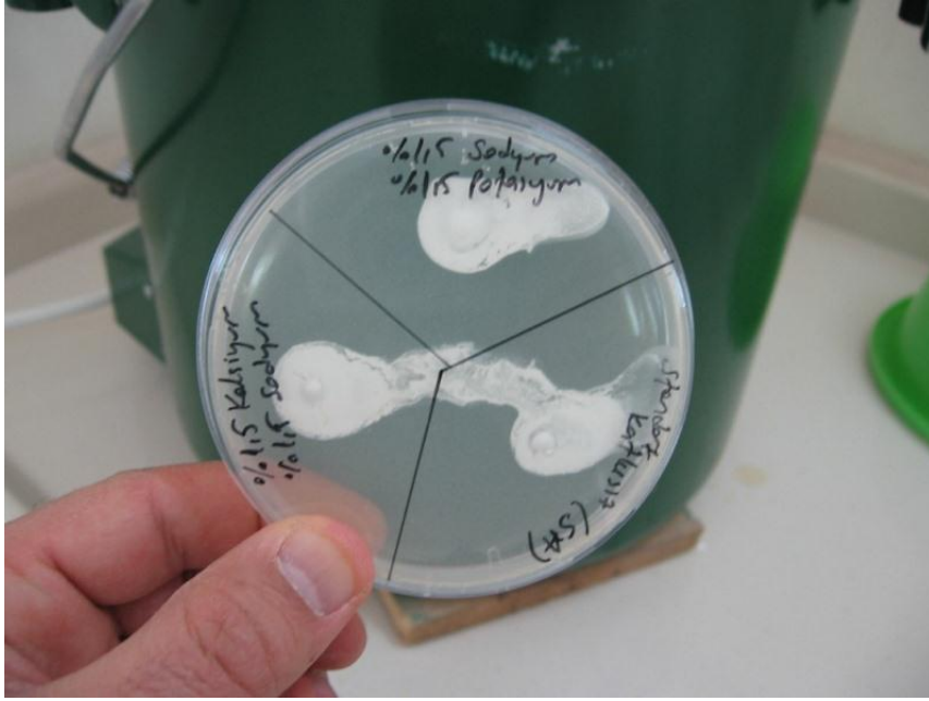
Resim 5.2. SA aşılannmış katkısız, %1 kalsiyum metaborat katkı ve %1,5 potasyum metaborat+%1,5 sodyum tetraborat katkı boya numunelerinin antibakteriyel etkinliklerinin tayini
