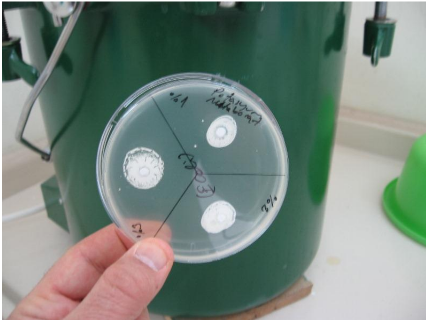
Resim 5.2. SA aşılannmış katkısız, %1 kalsiyum metaborat katkı ve %1,5 potasyum metaborat+%1,5 sodyum tetraborat katkı boya numunelerinin antibakteriyel etkinliklerinin tayini
