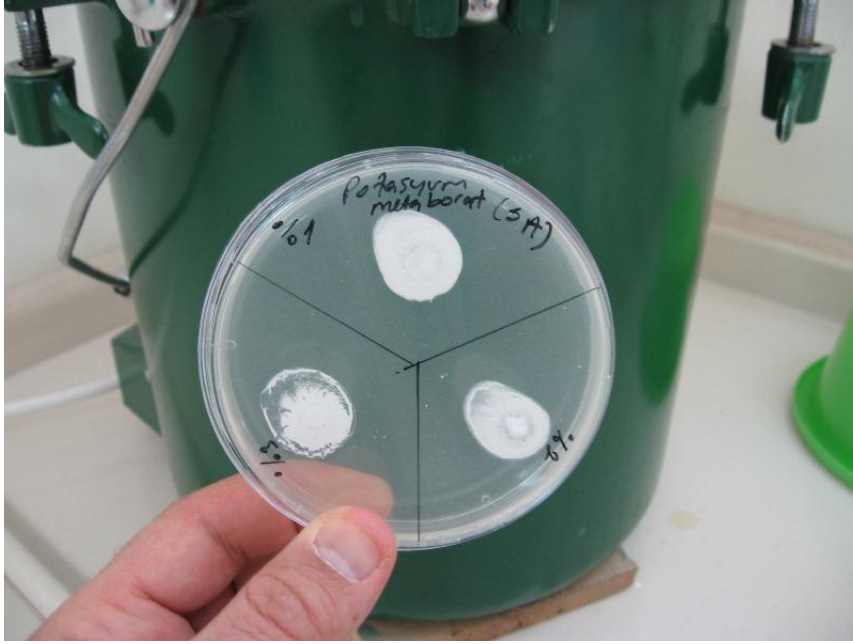
Resim 5.4. SA aşılانmış %1, 2 ve 3 potasyum metaborat katkılı boya numunelerinin antibakteriyel etkinliklerinin tayini
