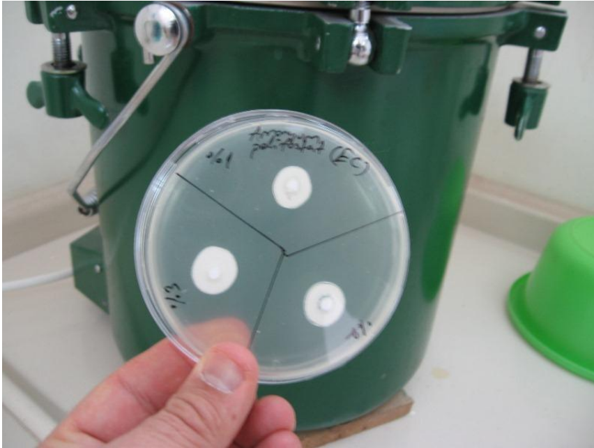
Resim 5.7. EC aşılannış %1, 2 ve 3 amonyum polifosfat katkılı boya numunelerinin antibakteriyel etkinliklerinin tayini
