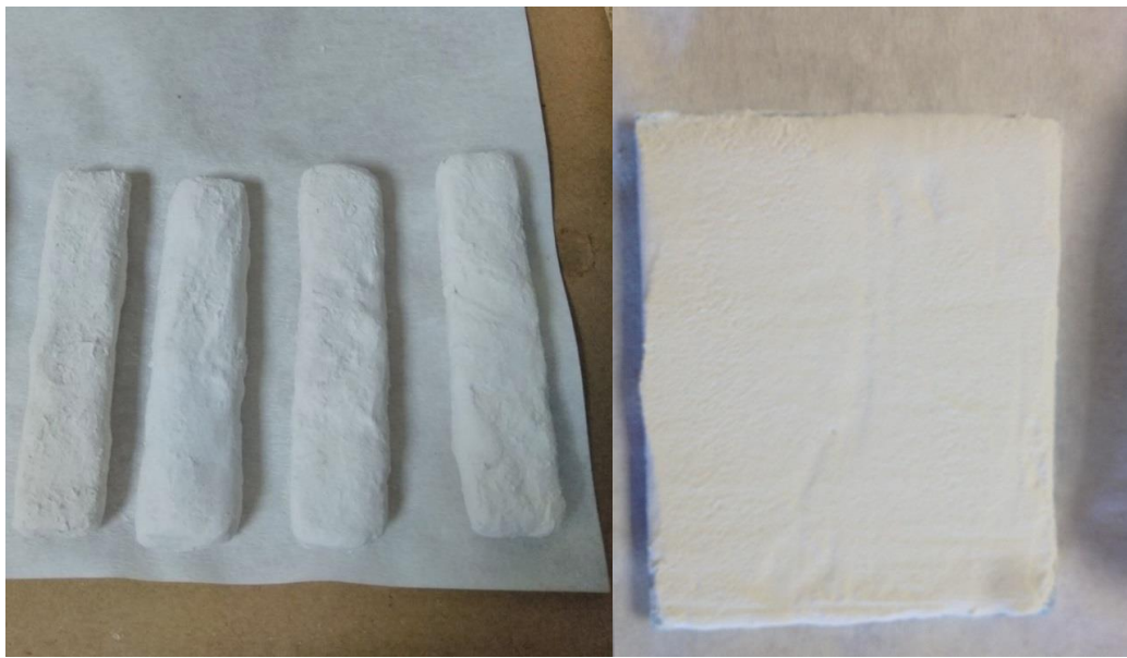
Resim 6.4. Deney öncesinde yüzeyleri kaplanmış köpük numuneleri
