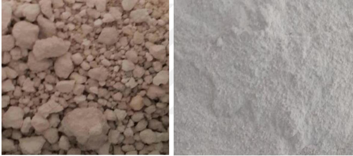
Resim 6.1. Alüminyum eloksal atığı ve ASTM 20 mesh numaralı elekten geçirilmiş elek altı toz numunesi
