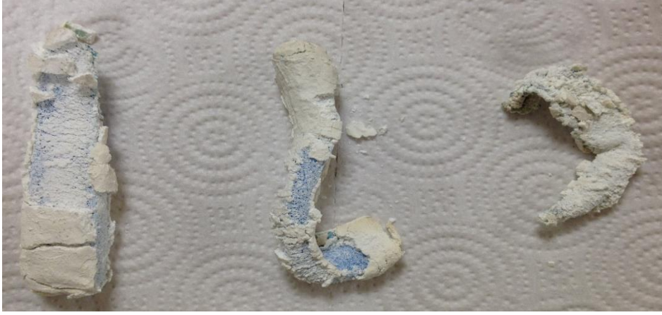
Resim 6.5. LOI testi sonrası köpük numuneleri
