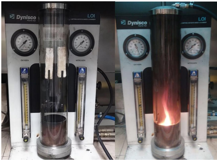
Resim 6.6. LOI testi öncesi ve test anındaki deney düzeneği
