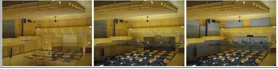
Resim 2.3. Soldan sağa yüksek tavan, alçak tavan ve alçak tavan + duvarda perde sistemi kullanımı (Ökvist ve diğerleri, 2008)
