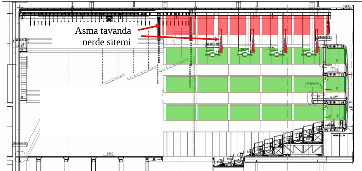
Şekil 2.11. Scene II Oditoryumunda tavanda bulunan perde sistemi (Buen ve Strand, 2008).
