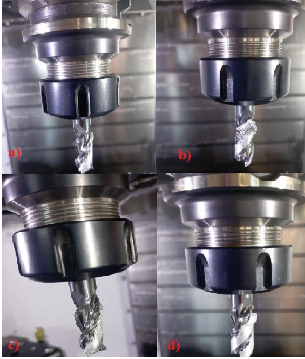
Resim 5.1. Kesici takımlarda meydana gelen yığıntı talaş oluşumu a) 0,2 (mm/dev), 300 (m/dak) 50F61 Takımı b) 0,2 (mm/dev), 350 (m/dak) 50F61 Takımı c) 0,25 (mm/dev), 300 (m/dak) 50F61 Takımı d) 0,25 (mm/dev), 350 (m/dak) 50F61 Takımı
