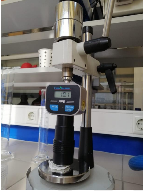
Resim 4.6. Shore-D sertlik analizi cihazı
