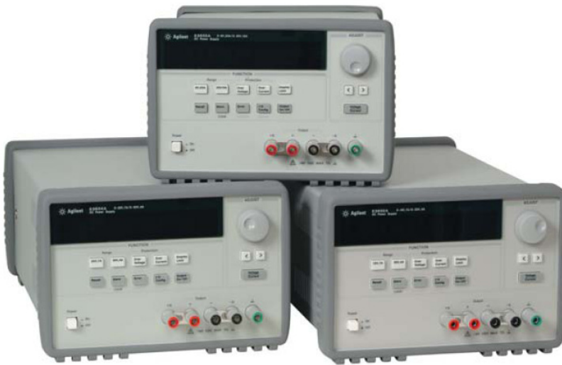
Resim 3.13. Doğru akım güç kaynağı – AGILENT E3634A
