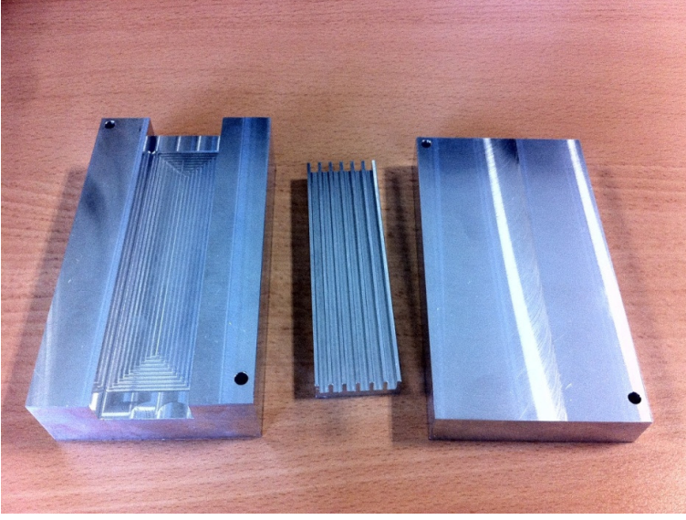
Resim 3.4. Sert lehimleme işleminden önce katı profil kanatçık, alt ve üst parçaları
