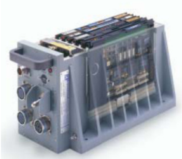
Resim 2.2. Soğuk plaka yardımıyla soğuyan elektronik sistemler
