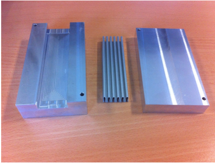
Resim 3.2. Sert lehimleme işleminden önce plakalı düz kanatçık, alt ve üst parçaları
