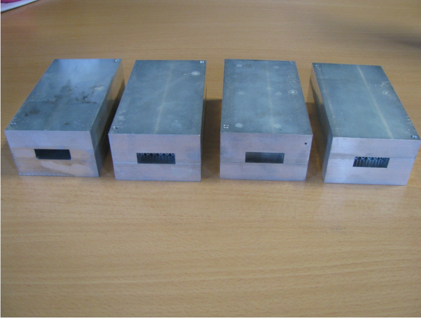
Resim 3.6. Sert lehimleme işleminden sonra kanatçıkların alt ve üst parçalara lehimlenmiş halleri
