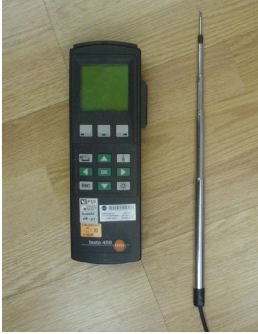
Resim 3.9. Kompakt anemometre – TESTO 400
