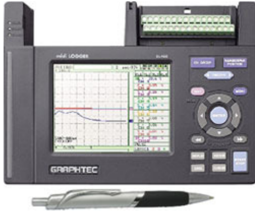
Resim 3.8. Veri kaydedici – GRAPHTEC GL450
