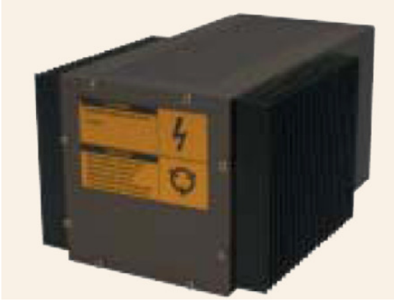
Resim 2.1. Doğal konveksiyonla soğuyan elektronik sistemler
