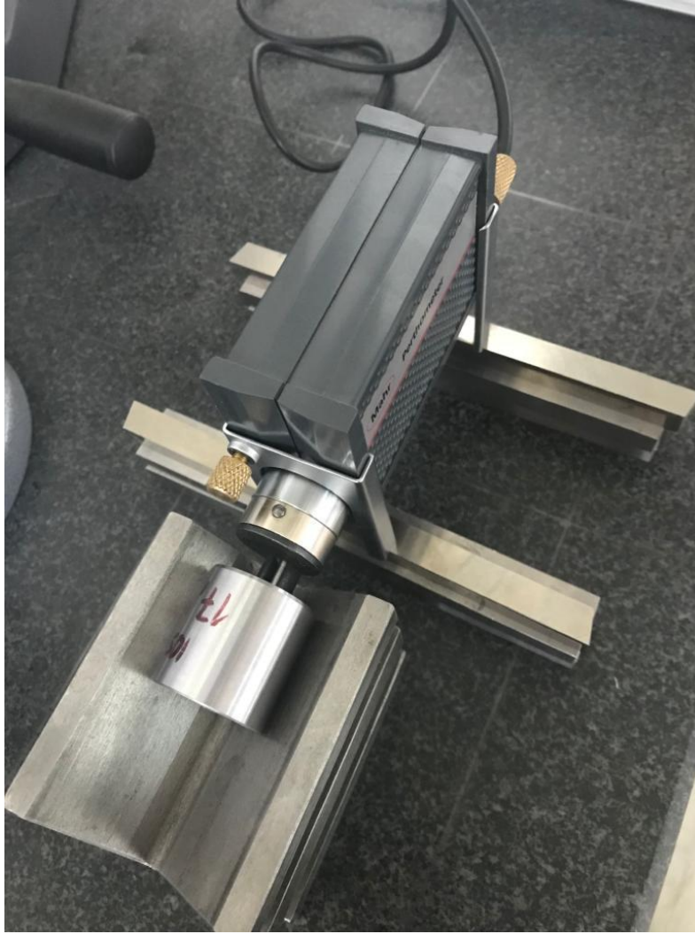
Şekil 4.10. Yüzey pürüzlülük değerinin ölçüm sırasındaki görseli
