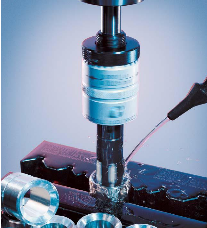
Şekil 2.12. Ezme takımının matkap tezgâhına bağlanma şekli [6]
