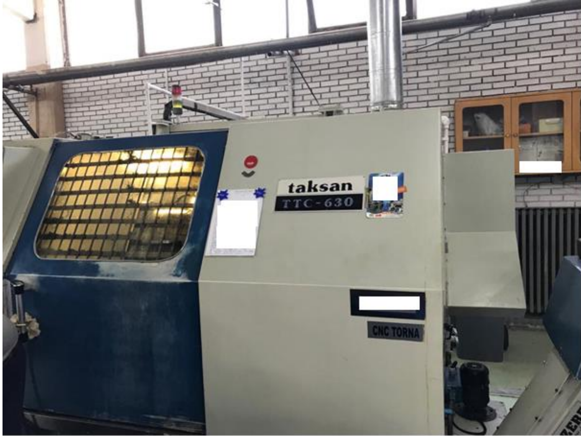
Şekil 4.2. Ön işlemin yapıldığı CNC torna tezgâhı
