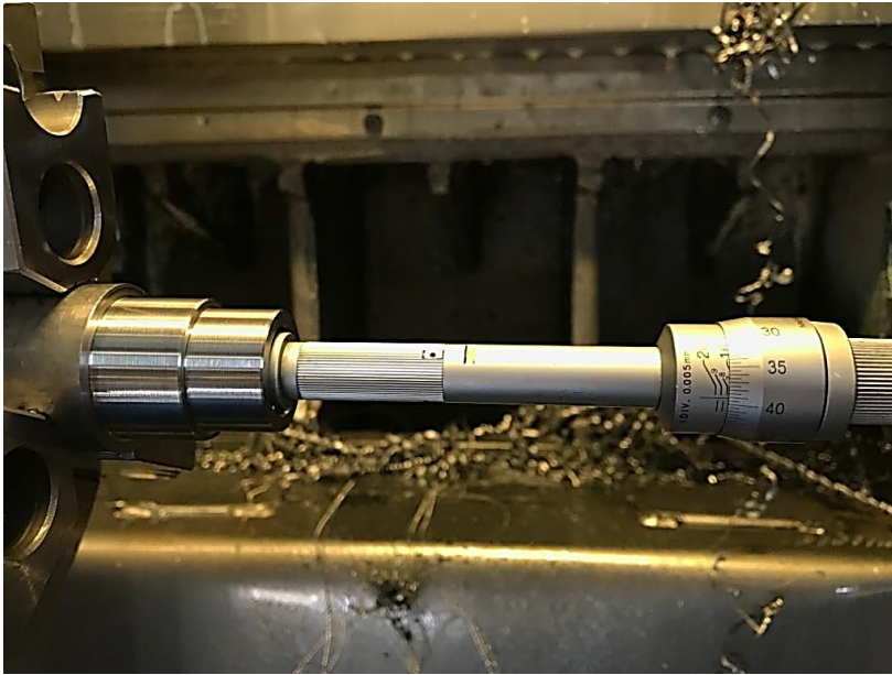
Şekil 4.5. İşlem sonrası iç çap mikrometresi ile ölçüm
