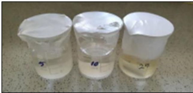
Şekil 4.4. Hibrit kaplama için hacimce a) %5, b) %10 ve c) %25 oranlarında Ta 2 O 5 karıştırılan HA çözeltileri
